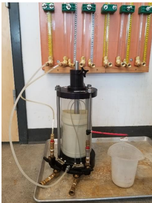
Figure 3.5: Perméamètre à paroi flexible utilisé pour les résidus et les résidus amendés
