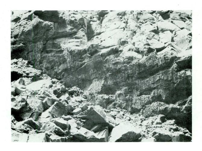
Fig. 12 - Stries bien nettes dans le plan de faille observé dans la tranchée à proximité de la station Beaugrand.
