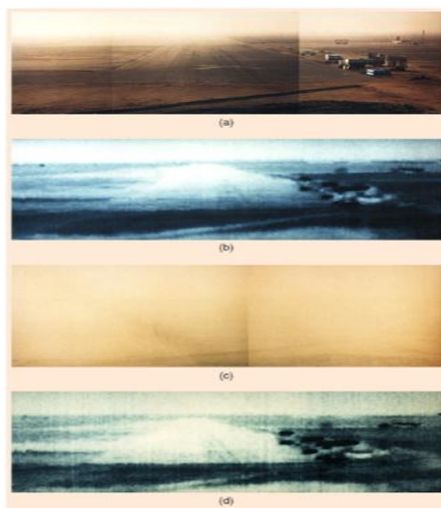
Figure 1.4 : Image d'une piste à 94 GHz: (a) et (c) montrent des images optiques sans et avec brouillard, alors que (b) et (d) montrent des images à ondes millimétriques sans et avec brouillard [Yujiri et al. (2003)].
