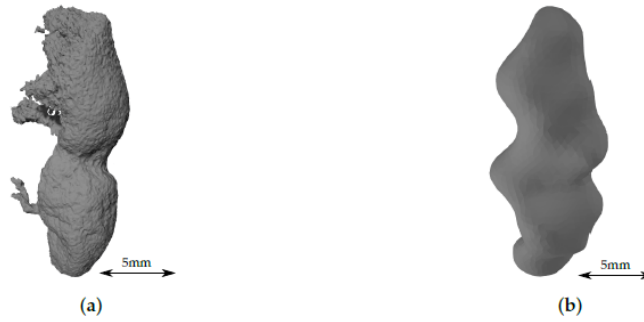
Figure 2.11 Cavité de retrait : (a) Numérisation CT et (b) Modèle numérique généré après lissage de la surface (reproduite et adaptée de [40], sous licence Creative Commons)
