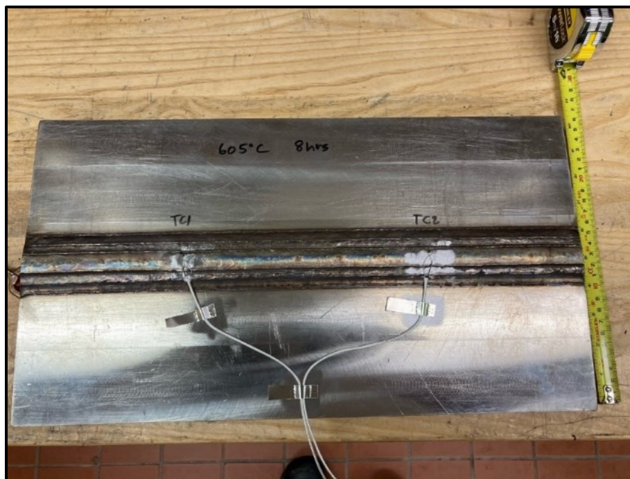
Figure 4.6 Installation des thermocouples pour le traitement thermique suivant le soudage de la plaque
