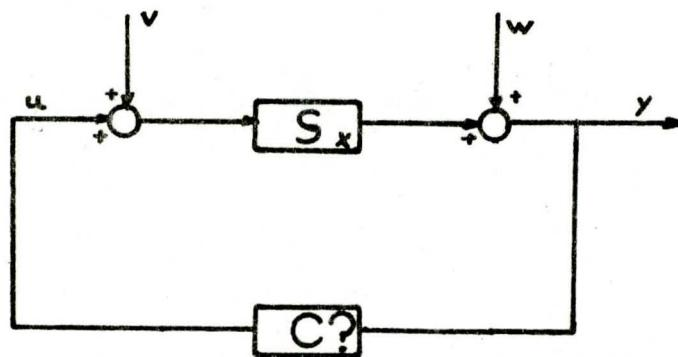
Fig. 1 Configuration générale des systèmes sujets aux perturbations extérieures.
