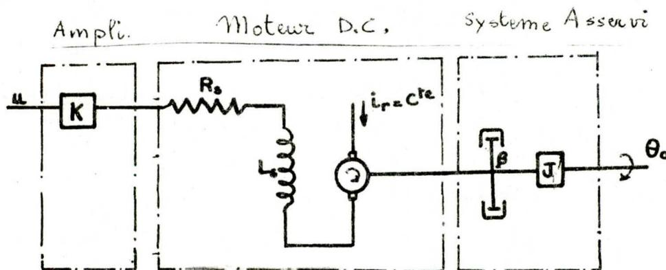
Fig. 2 Servomécanisme de position.
