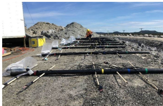
b) Fabrication des arbres à sondes
