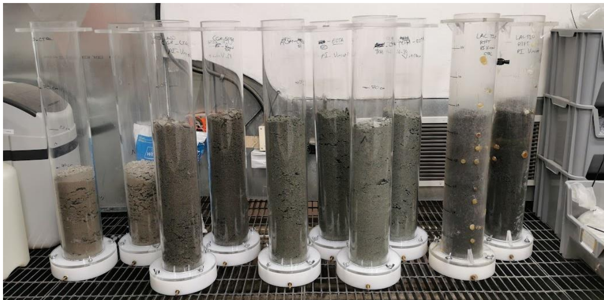
Figure 3.5 Colonne de stériles (Malartic et TIO) avant le début des rinçages. De gauche à droite : CPO CTRL, CPO EDTA, CGR CTRL, CGR EDTA, AUM CTRL, AUM EDTA, TCH CTRL, TCH EDTA, TIO CTRL, TIO EDTA.
