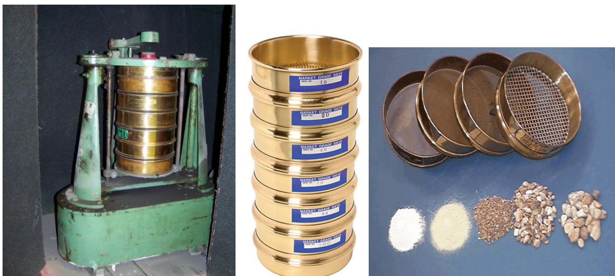
Figure 2.19 Tamiseur utilisé dans ce projet, Série de différents tamis utilisés pour un essai granulométrique.
