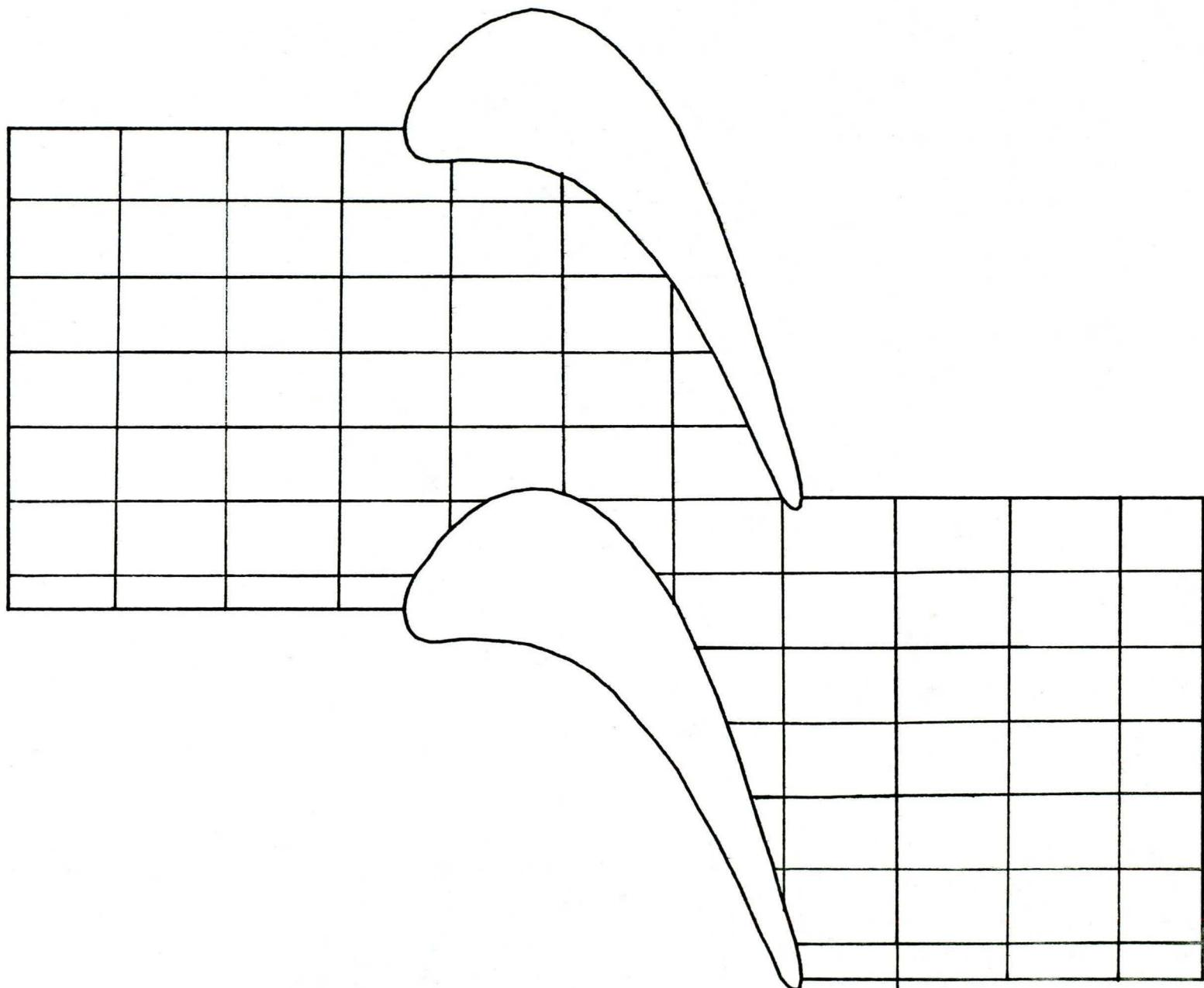
FIG. 1 RECTANGULAR GRID IN PHYSICAL COORDINATES FOR A TYPICAL CASCADE.
