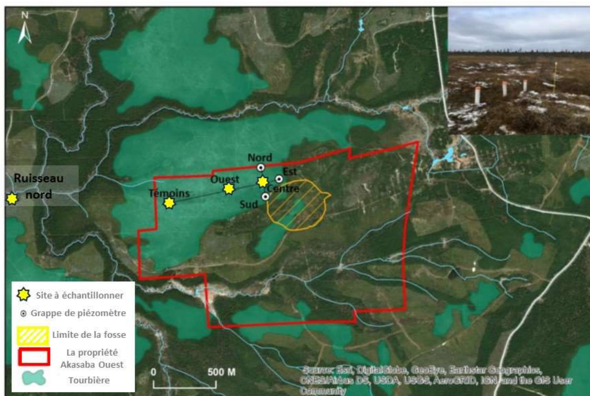
Figure 4.1 Schéma conceptuel représentant les grappes de puits d'observation Adaptée de (Kraouaia, 2020)
