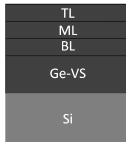
Figure 2.4 Schéma d'un empilement de couches de \text{Ge}_{1-x}\text{Sn}_x avec x croissant, sur un substrat virtuel de Ge, pour minimiser les contraintes dans la couche supérieure (TL). Ge-vs : substrat virtuel ( virtual substrate ) de Ge ; BL : couche inférieure ( bottom layer ) ; ML : couche intermédiaire ( middle layer ) ; TL : couche supérieure ( top layer ). Schéma reproduit avec la permission de [6].
