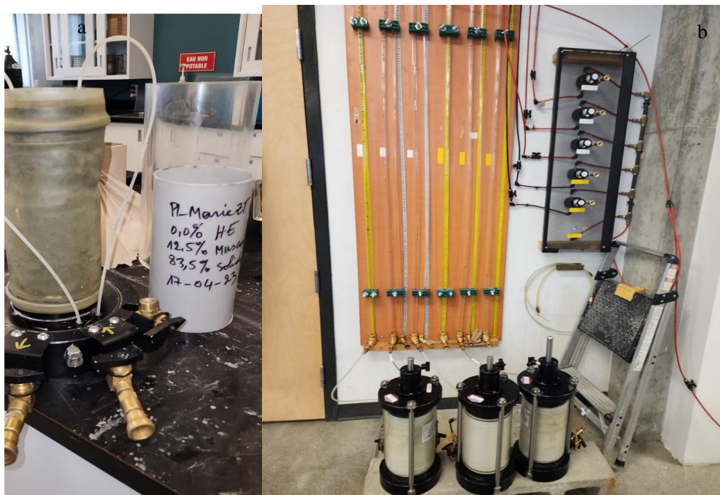
Figure 3.12 Moule & échantillon dans la membrane (a) et Permeamètre à paroi flexible (b) utilisé pour les essais de conductivité hydraulique
