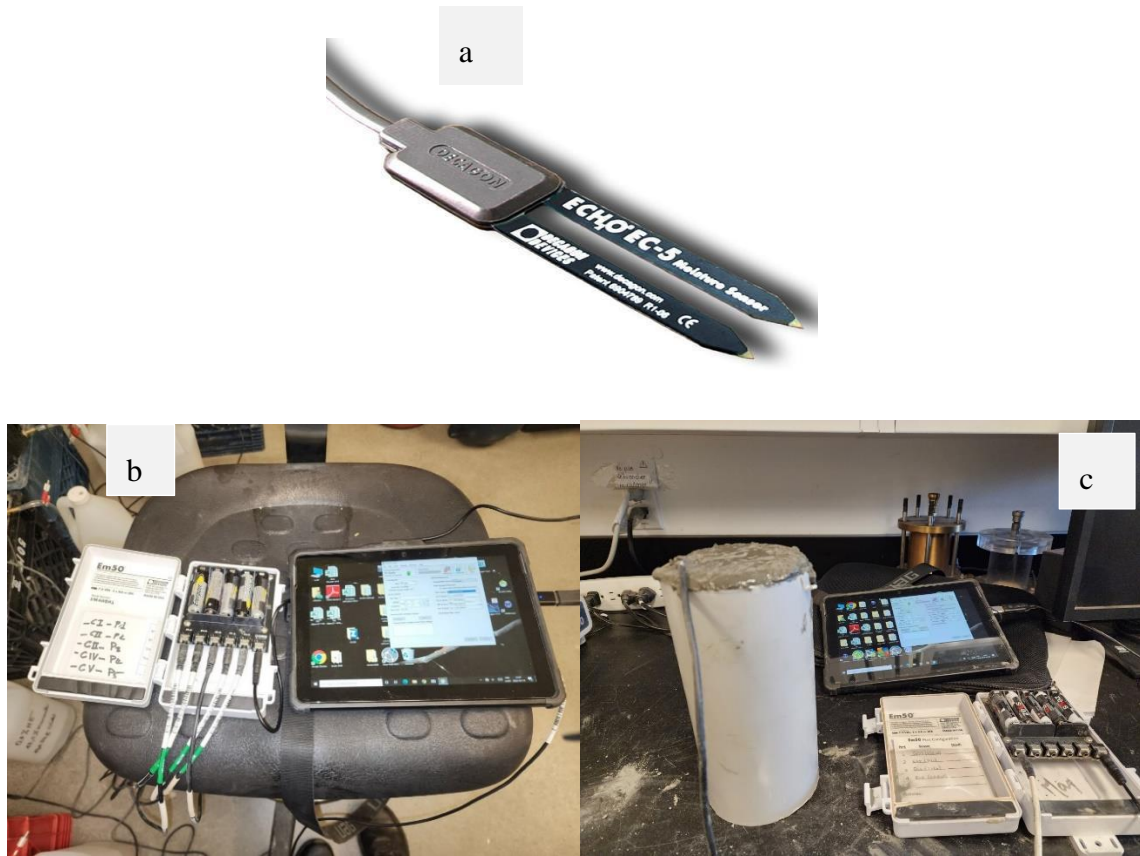
Figure 3.17 a & b Sonde EC-5 pour la mesure de la teneur en eau volumique (a) et les pesées de calibration (b)
