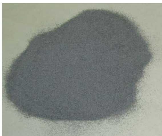
Figure3-7: Dépôt de carbone à la surface du catalyseur
