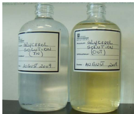
Figure 3-1: Comparaison entre la solution d'entrée et la solution de sortie lors de l'évaporation à haute température de la glycérine
