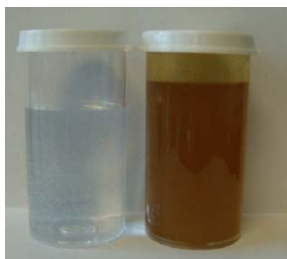
Figure 3-2: Différence entre la solution glycérine-eau et le produit accumulé au fond du réacteur
