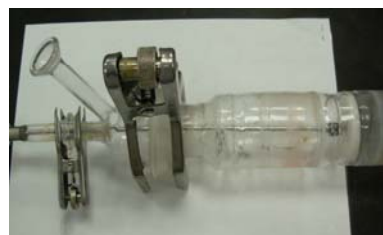
Figure 2-6: Lignes d'injection du liquide et du gaz au fond du réacteur
