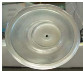
Figure 2-5: Emplacement du distributeur en céramique dans le tube avec un trou au milieu par lequel passe le tube d'injection du liquide.
