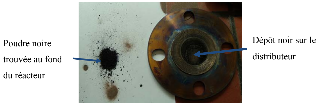
Figure 3-2: Différence entre la solution glycérine-eau et le produit accumulé au fond du réacteur
