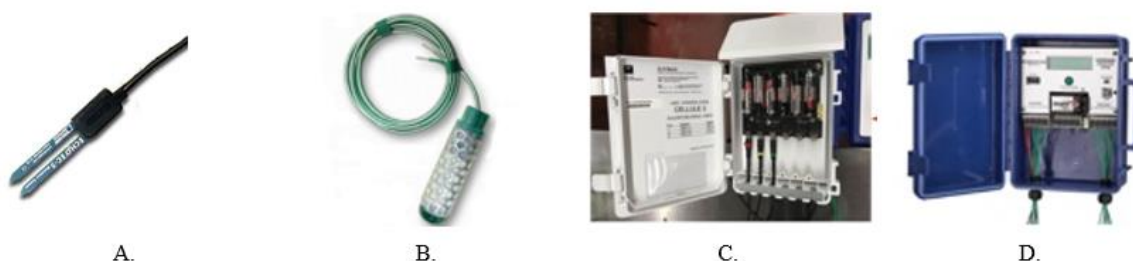
Figure 3.4. Instruments de mesure : A) sondes de type Echo EC5 pour les mesures des teneurs en eau volumiques, B) sondes de succion type Watermark pour les mesures de succions, C) système d'acquisition des données METER ZL6 pour les mesures de teneurs en eau volumiques, D) système d'acquisition des données IRROMETER 900M-O pour les succions.
