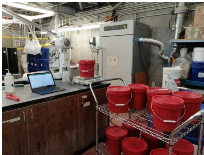
Figure 3.7. Pesage de chaudières pour la mesure de l'infiltration et le ruissellement.
