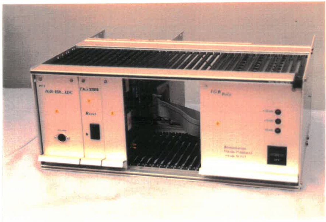
Figure 2.12: Photographie du système complet: 1. carte d'acquisition 2. carte d'unité centrale de traitement 3. carte de sorties 4. bloc d'alimentation.
