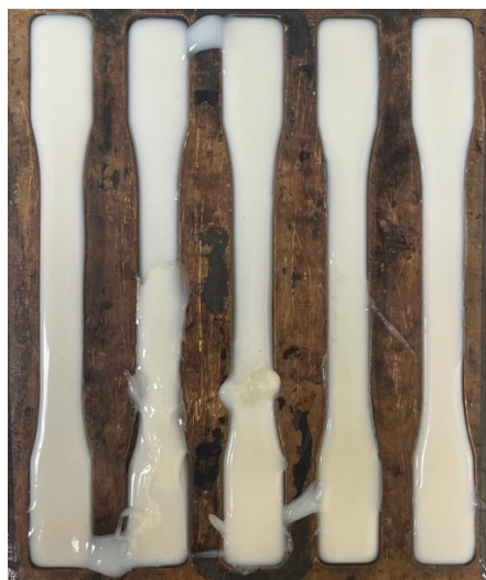
Figure 3.8. Photo du moule des échantillons de traction ASTM D638 type IV dogbones ASTM D638
