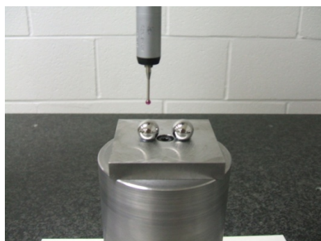
Figure 3-14 : Montage utilisé pour valider les erreurs machine dans un petit volume de mesure de la MMT.
