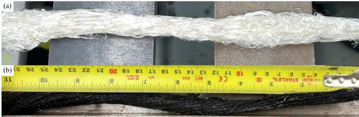
Figure A1 Image montrant les fils CW (a) et les fils DREF (b) extraits de la chambre de préchauffe à la fin de l'expérience de pultrusion. Les fils CW présentent un retrait du polymère entraînant des ondulations des fibres, tandis que les fils DREF n'en présentent pas.
