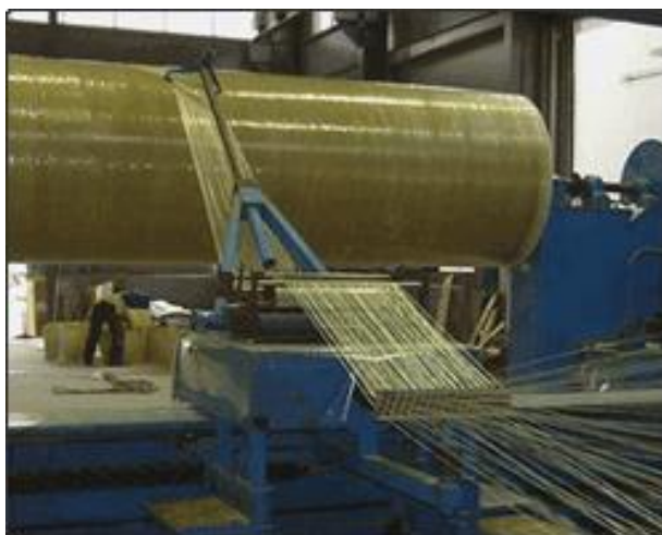
Figure 1-2: Exemple de fabrication par enroulement filamentaire (photo de : http://www.gilgwang.com/english/frp/grp01.html )
