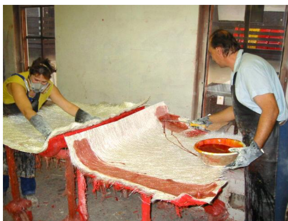
Figure 1-1: Fabrication par hand lay-up (photo de : http://www.petergfk.com/en/technology/ )
