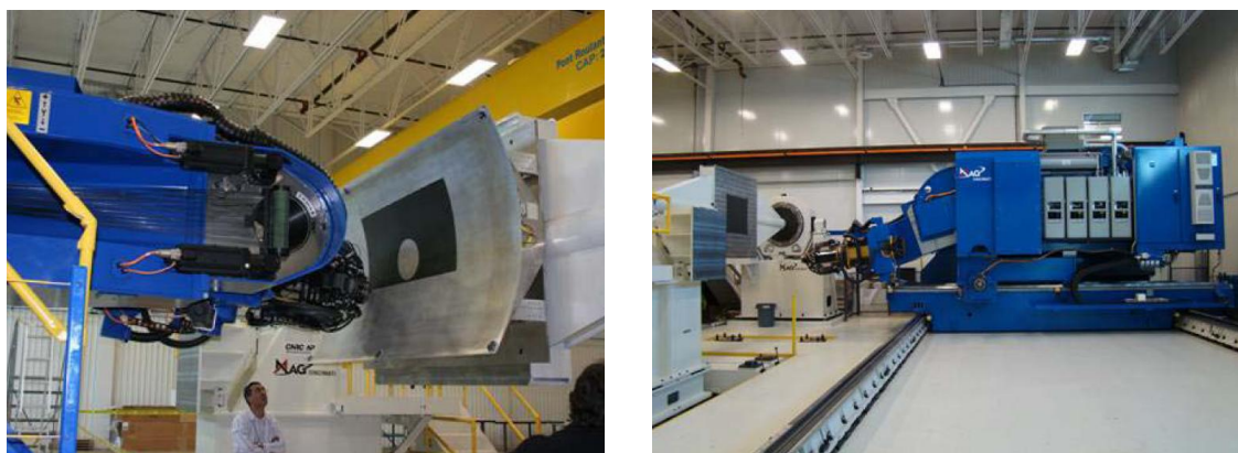
Figure 1-4 : Machine de placement de fibres utilisée pour fabriquer les matériaux du projet, plan sur la tête de placement de fibres et vue d'ensemble
