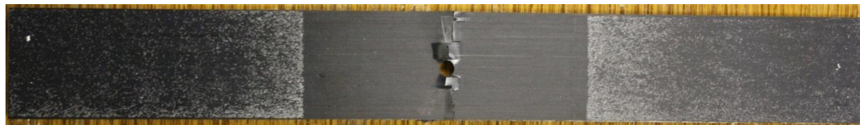
Figure 3-3 : Rupture observée sur les éprouvettes de compression après impact
