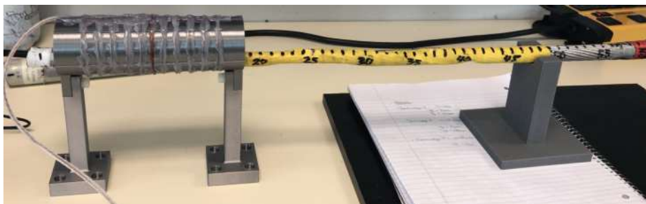
FIGURE 6.10 Exemple de mesure d'un échantillon dégradé. Les mesures doivent être prises à chaque centimètre si l'on veut tracer le profil de dégradation tout au long du conducteur.
