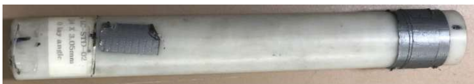
FIGURE 6.9 Étalon à 57 brins d'aluminium utilisé pour la calibration des mesures (LC-STD-02 selon l'appellation d'Hydro-Québec).
