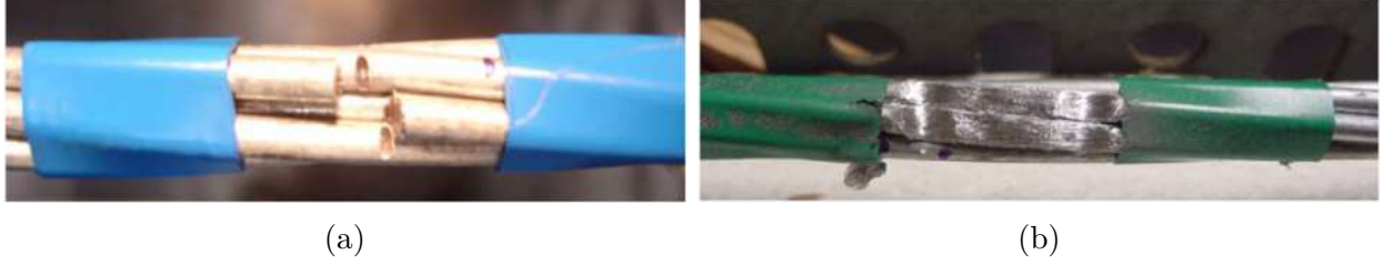
FIGURE 2.1 Anomalies évaluées lors des inspections LF et LMA, respectivement : (a) échantillons à brins cassés et (b) échantillons à perte de section transversale. Adapté de Pinto [13]
