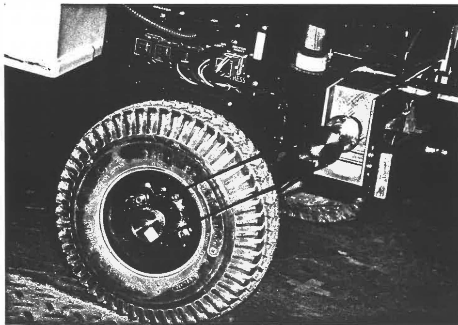
Figure 3.4: Localisation d'un encodeur optique sur une roue.
