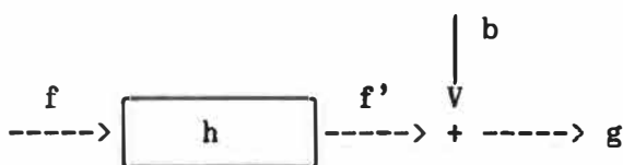
Figure 2.5.1 Modèle de formation d'images avec fonction de dégradation et bruit aléatoire additif.
