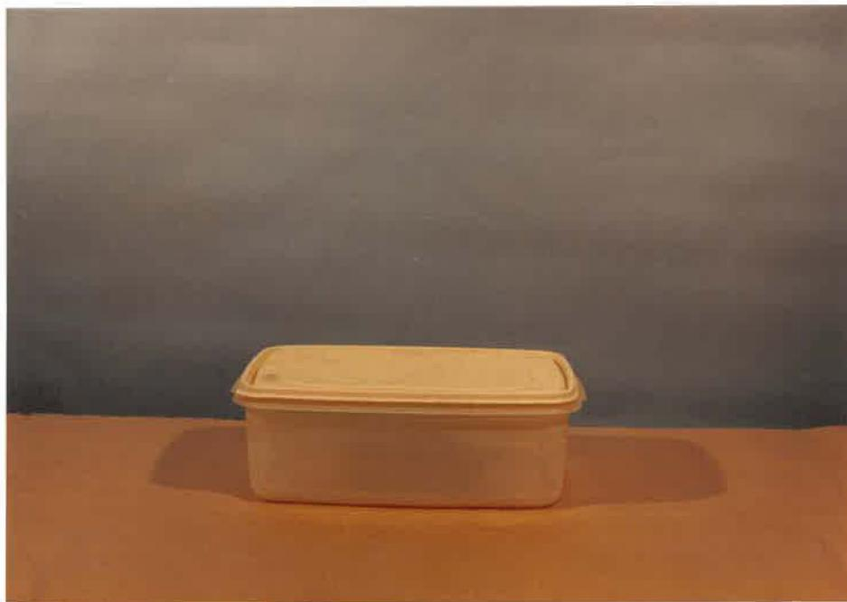
Fig. 45-Réceptient horizontal utilisé lors de la cure de l'essai accéléré avec prismes de béton.
