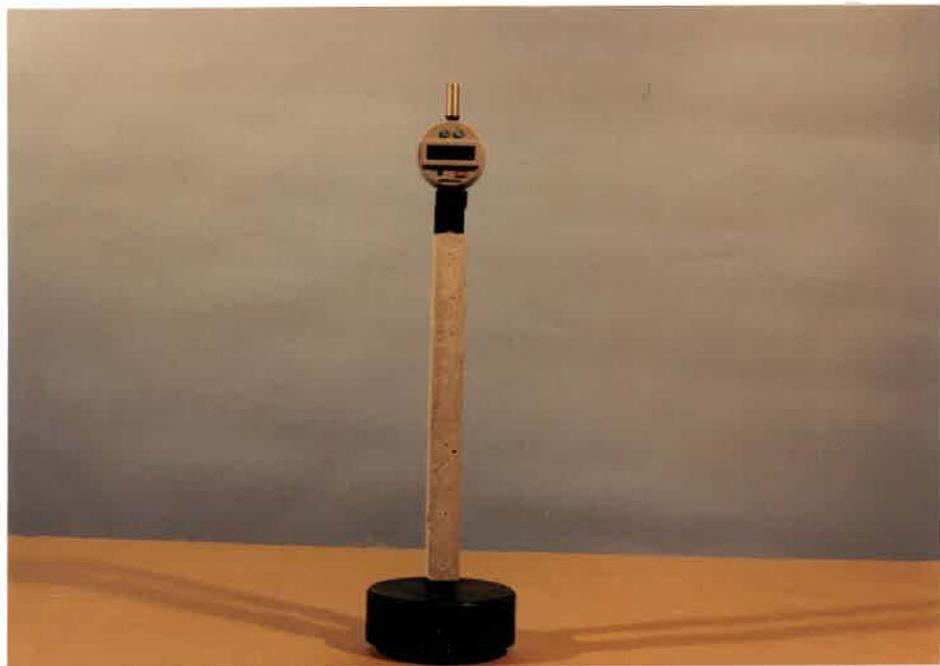
Fig. 47-Appareil de mesure utilisé pour les prismes de béton.
