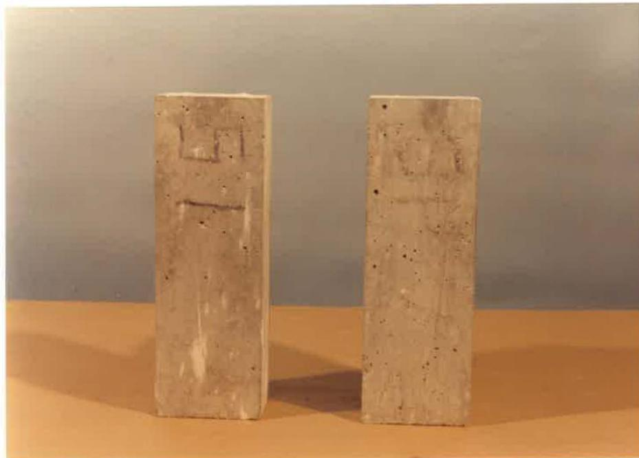
Fig. 15-Prismes de béton selon la norme ACNOR A23.2-14A.
