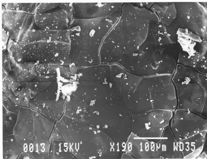
Fig. 69-Photographie prise au MEB montrant un gel calco-alcalin-siliceux produit lors de l'essai accéléré avec le calcaire d'Ottawa. (190X)
