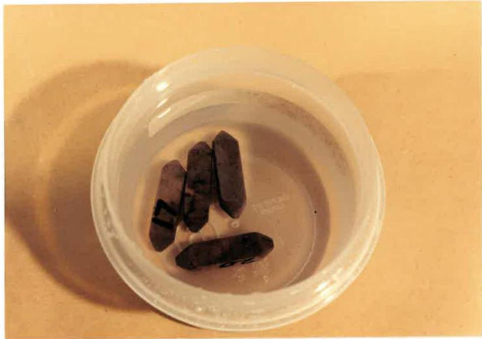
Fig. 13-Mini-prismes de dolomie, selon la norme ASTM C-586.
