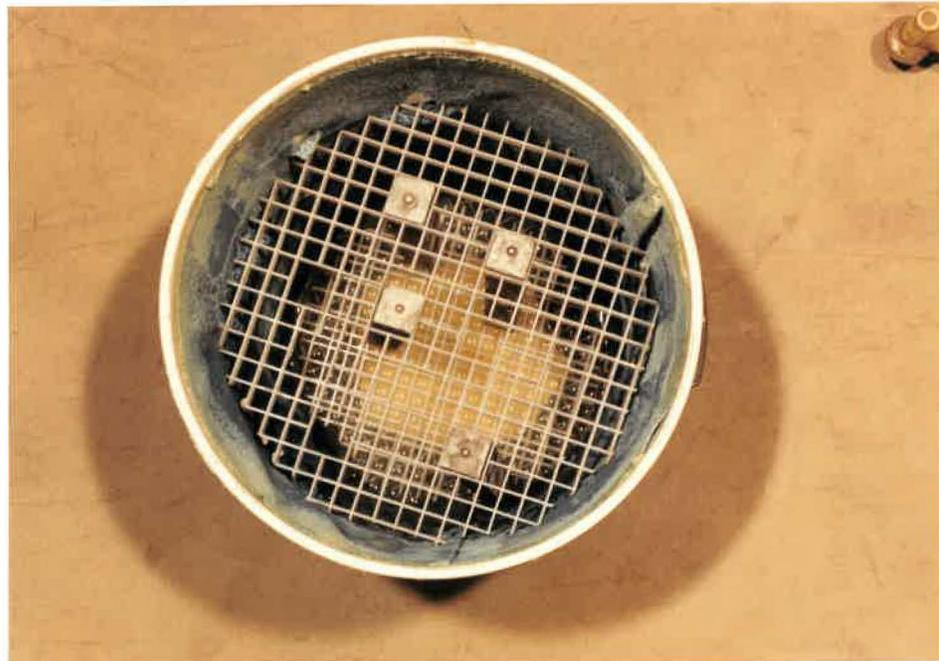
Fig. 12-Réceptacle utilisé pour l'essai ASTM C-227.
