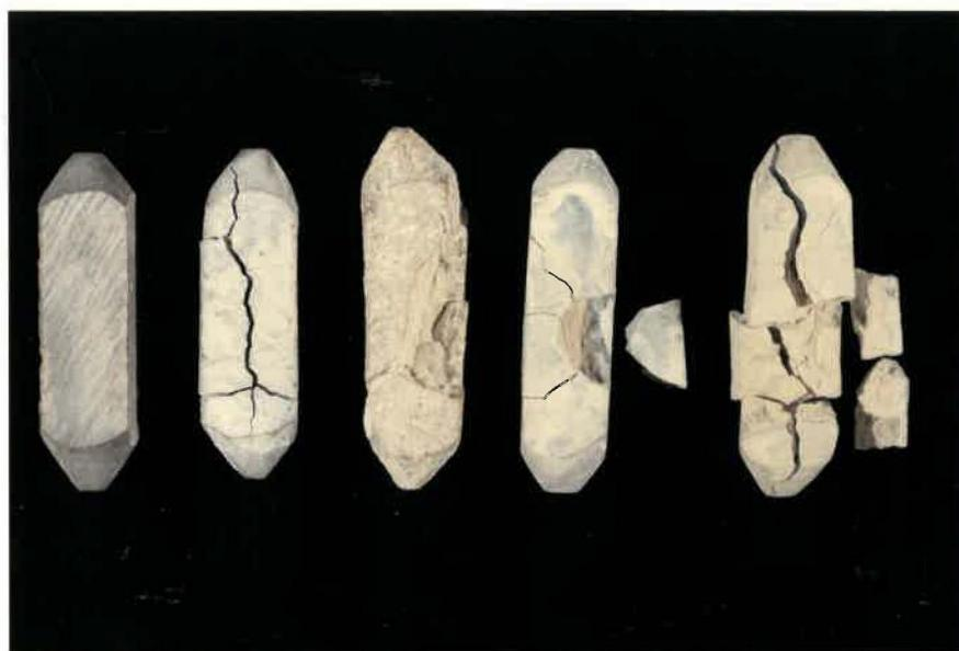
Fig. 65-Mini-prismes de dolomie ayant subit différentes cures: de gauche à droite, eau distillée à 80°C, NaOH 1N à 80°C, 1 mois, 2 mois, 3 mois et 4 mois.
