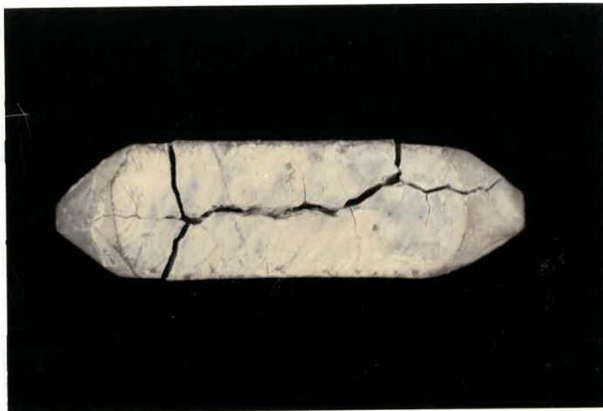
Fig. 66-Mini-prisme de dolomie après une cure d'un mois dans de la soude 1N à 80°C.
