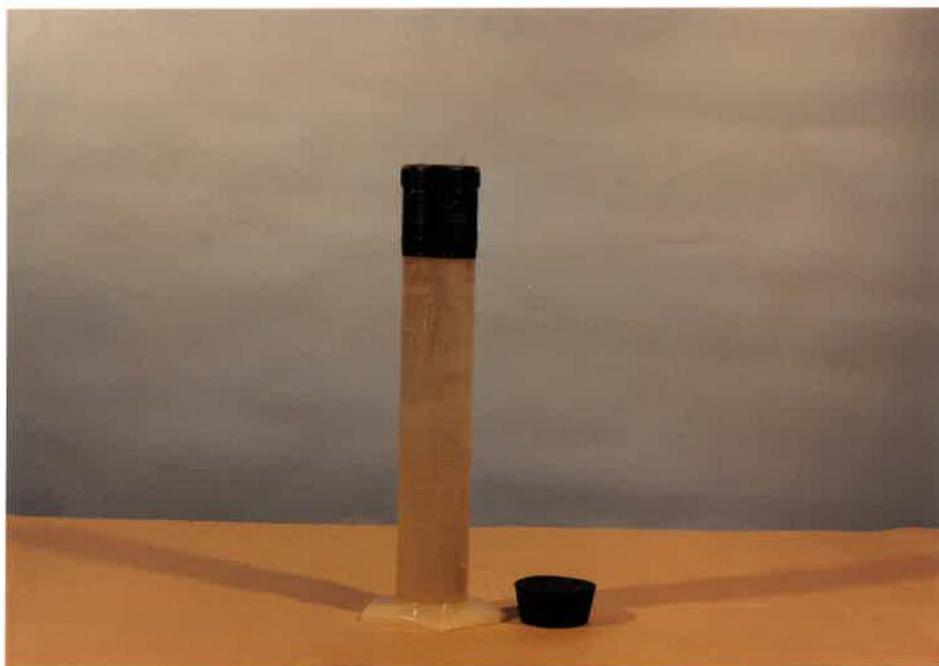
Fig. 43-Réceptacle utilisé lors de la cure de l'essai accéléré sur barres de mortier.
