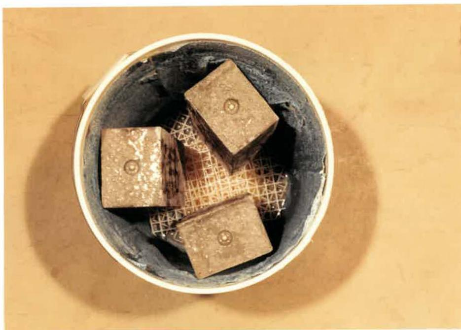
Fig. 16-Réceptacle utilisé pour la cure de la norme ACNOR A23.2-14A.
