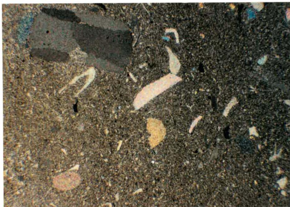
Fig. 30-Photographie du calcaire de Berthier en lame mince. (lumière polarisée, 32X)
