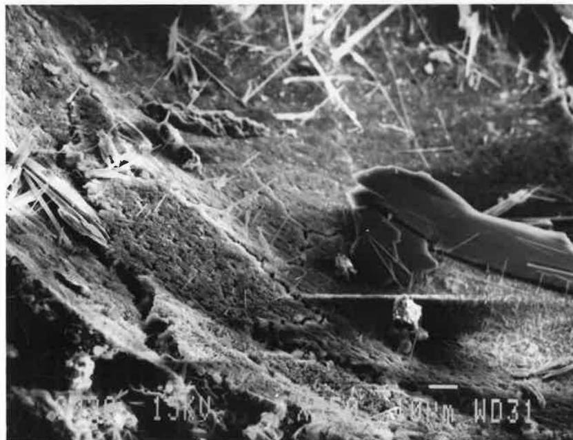
Fig. 79-Photographie prise au MEB montrant un gel calco-alcalin-siliceux produit lors de l'essai ASTM C-227 avec le calcaire d'Ottawa. (250X)
