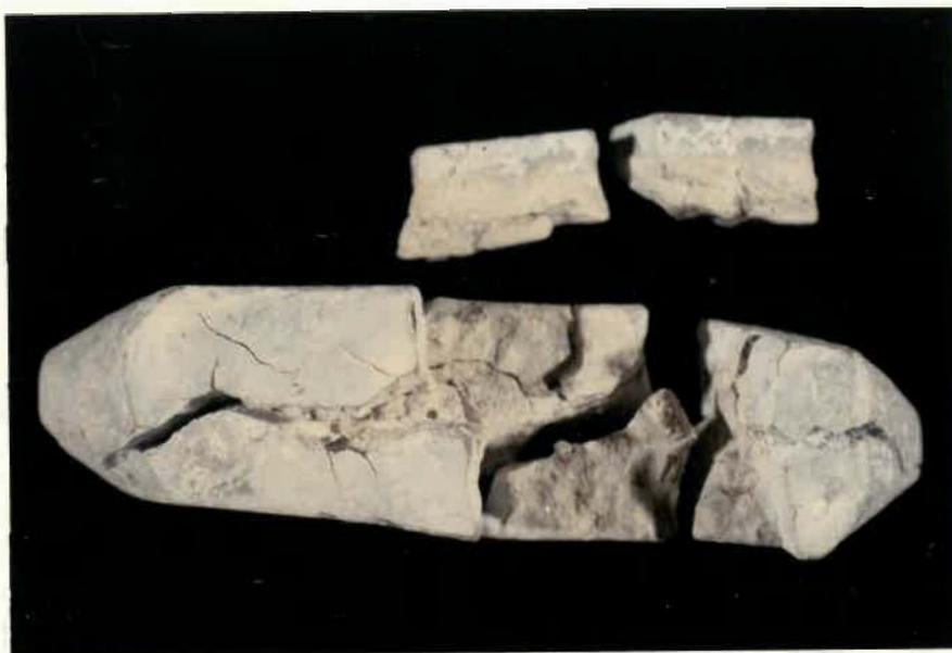
Fig. 68-Mini-prisme de dolomie après un séjour de quatre mois dans de la soude 1N à 80°C.
