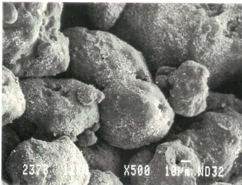
Figure 3.23 - Morphologie à l'intérieur d'une pré-forme contenant 4% de FREQUON et chauffée à 185 °C
