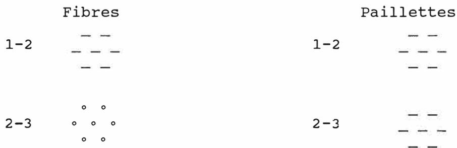
Figure 1-1. Distribution des contraintes en fibres et paillettes. D'après Rayson (1986).
