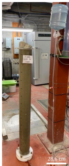
Figure 3.4 Essai de drainage en colonne pour obtenir la courbe de rétention d'eau du sable
