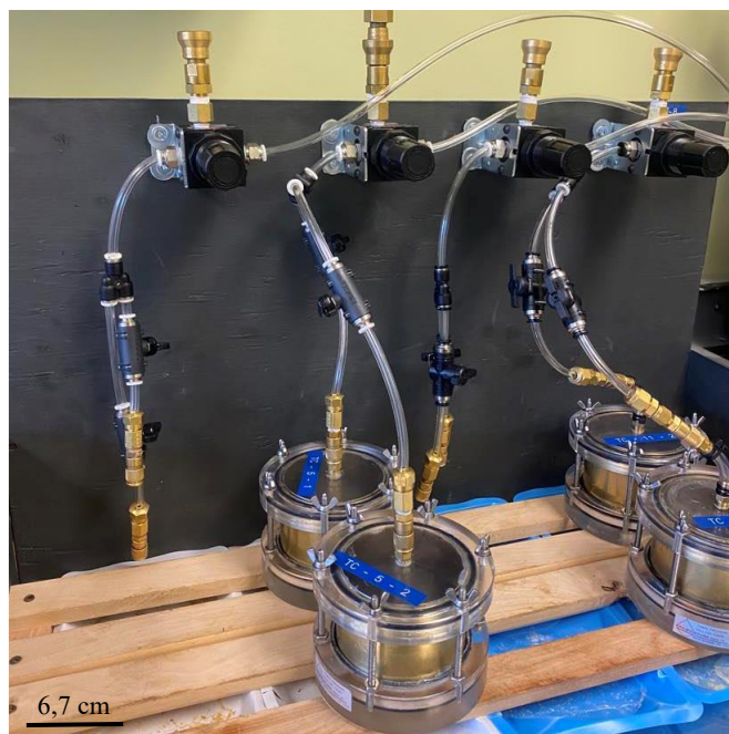
Figure 3.3 Cellules de Tempe branchées à une bombonne d'azote
