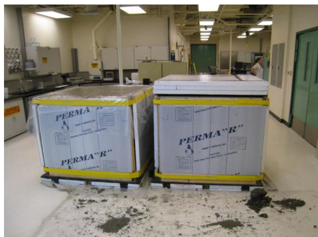
Figure 3-2 : Essais adiabatique et semi adiabatique, tiré de (Lawrence, Tia et al. 2012).
