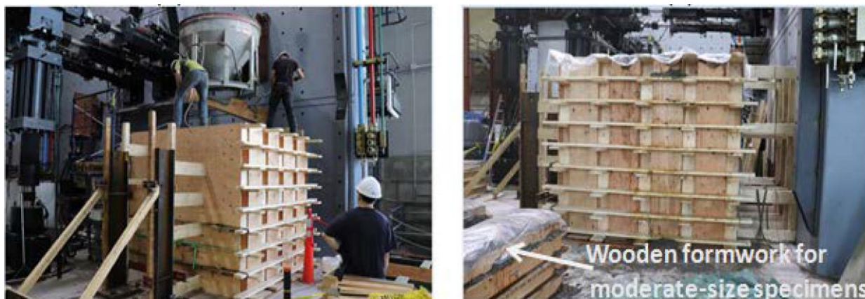
Figure 3-22 : Coulage et curée des grands spécimens, tiré de (Bakour 2021).
