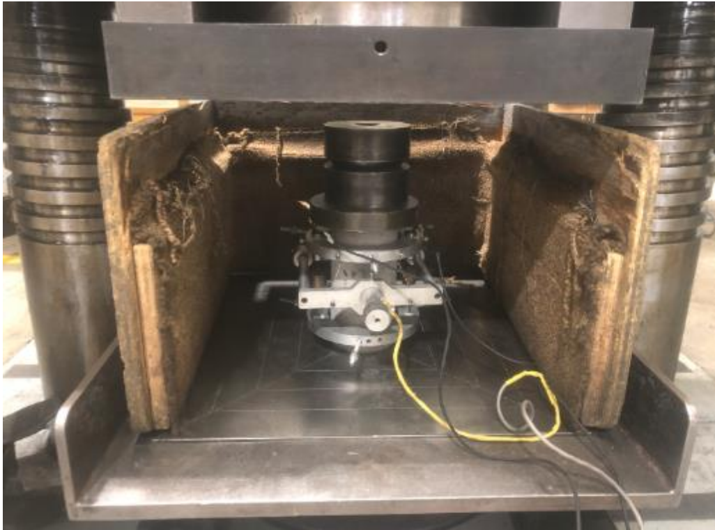
Figure 4.15 Montage pour la mesure du module élastique et du coefficient de Poisson
