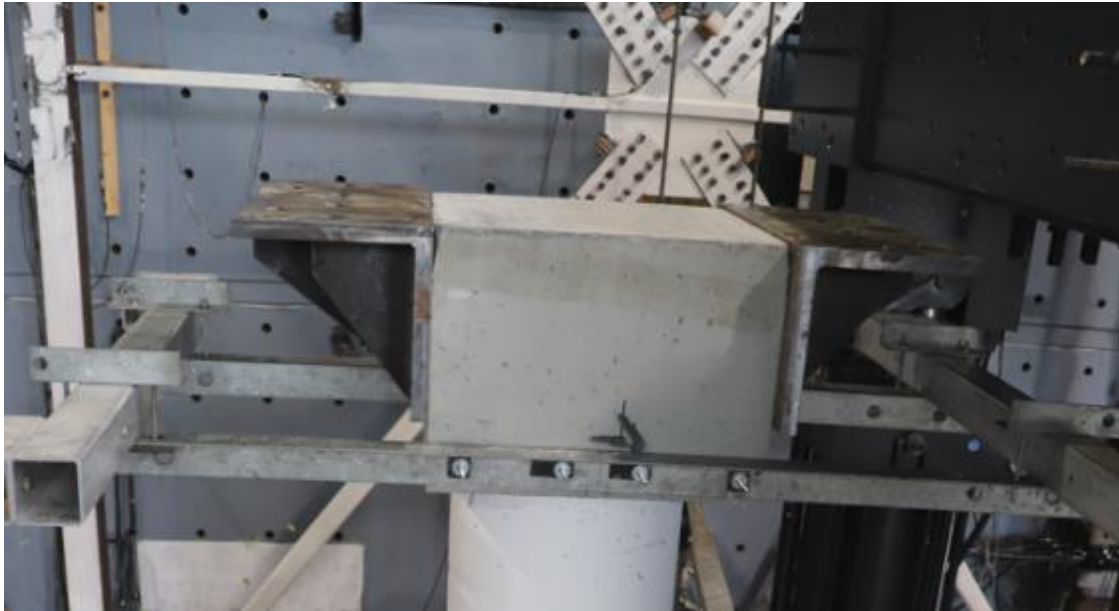
Figure 4.49 Équerres dépassant légèrement du dessus du chevêtre (P5)
