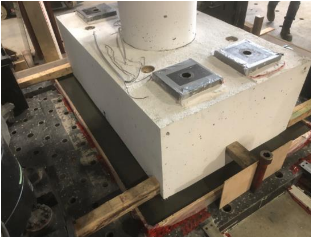
Figure 4.48 Coulis cimentaire sous le spécimen P5
