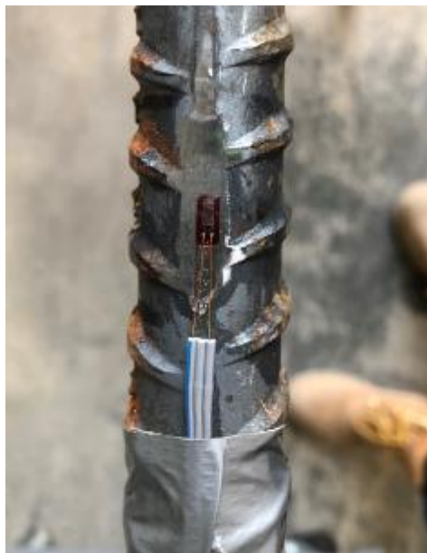
Figure 4.36 Jauge collée - avant protection
