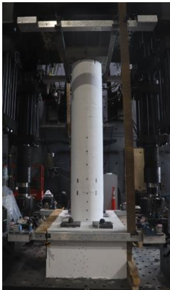
Figure 4.46 Cibles pour utilisation de la numérisation 3D
