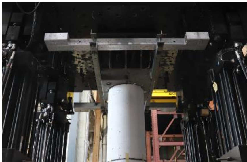
Figure 4.45 Mesure du déplacement relatif – instrumentation en haut de la colonne (P5)
