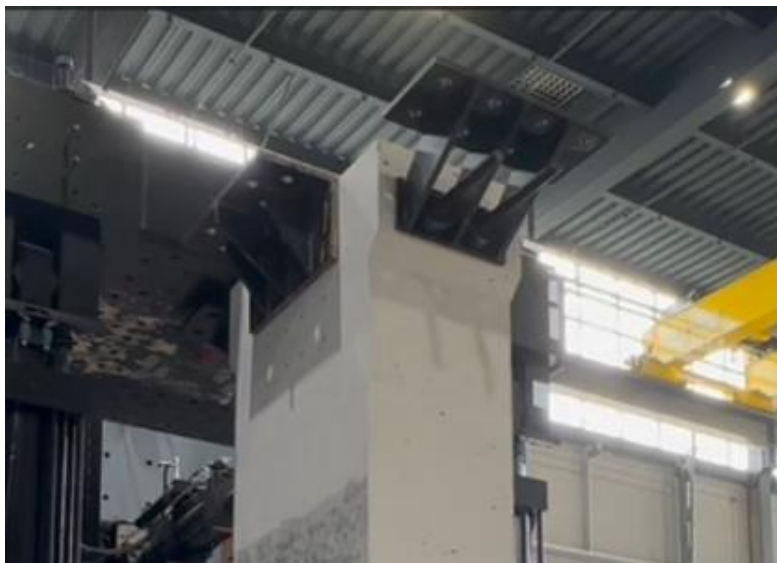
Figure 5.34 Équerres au sommet de la colonne
