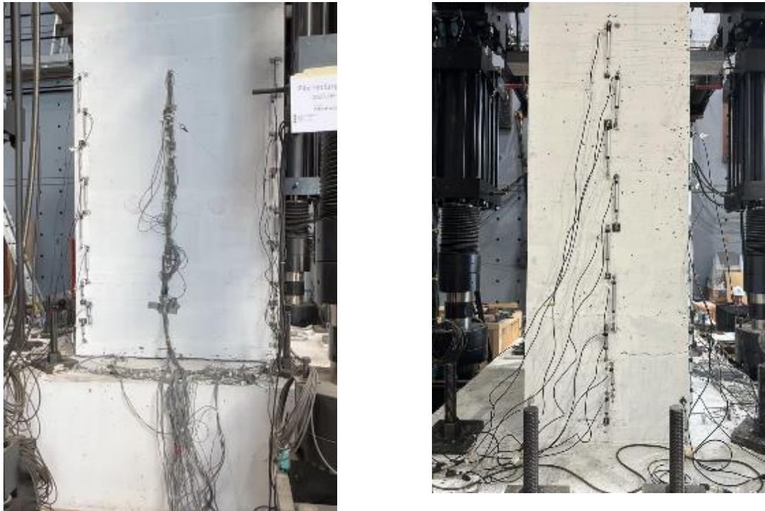
Figure 5.27 Montage des LVDT
