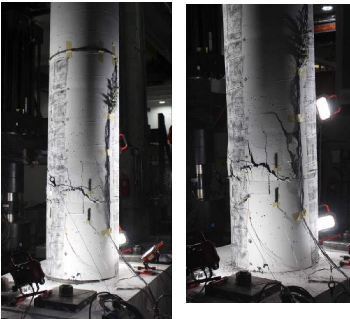
Figure 4.59 Pile P5 à 7\Delta_y
