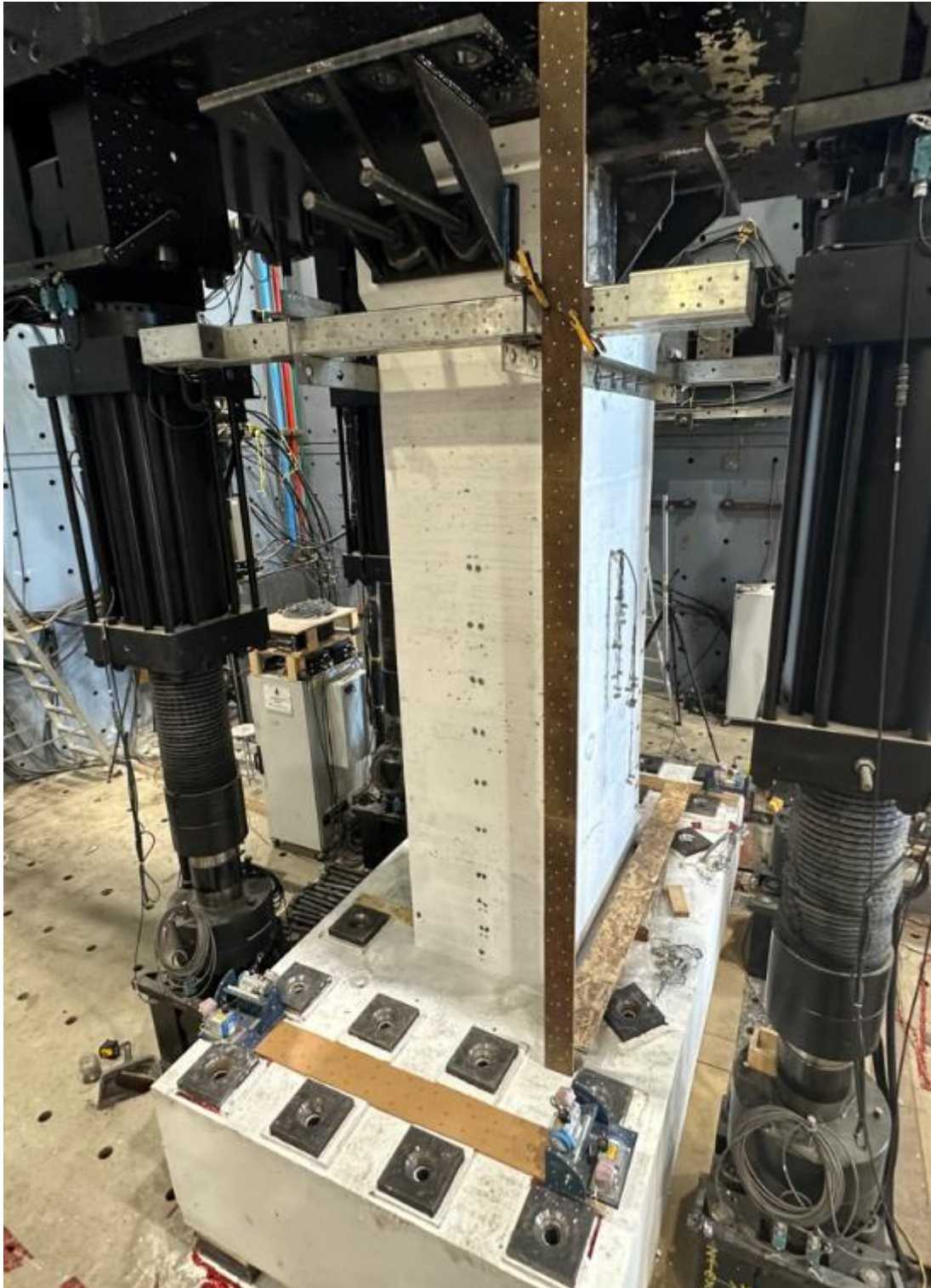
Figure 5.30 Installation de cible pour la numérisation 3D
