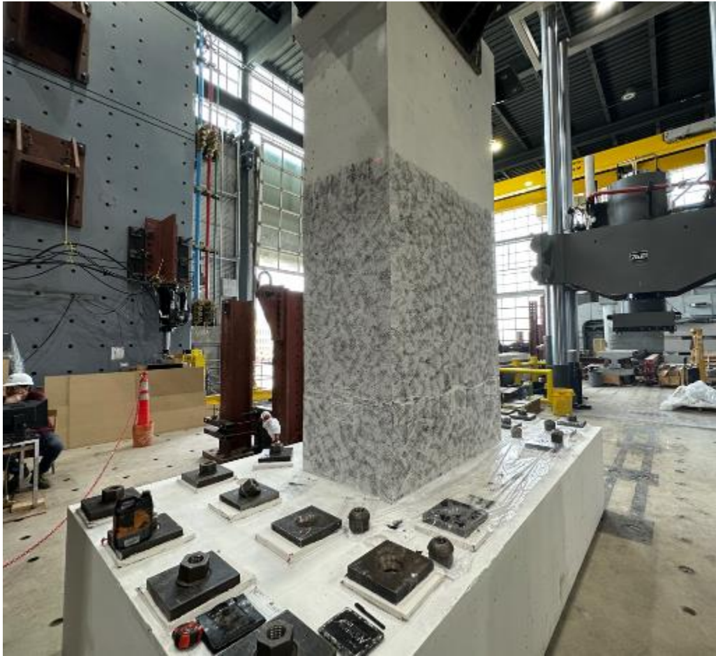
Figure 5.28 Mouchetis pour le système de corrélation d'images
