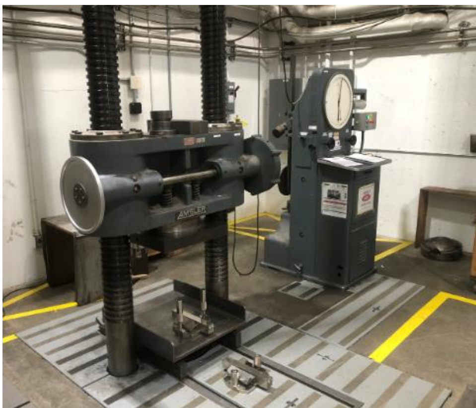
Figure 4.14 Presse de 4.45 MN utilisée pour les essais de compression et de module
