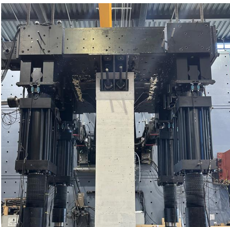
Figure 5.35 Équerres ancrées au plateau supérieur du 6DDL
