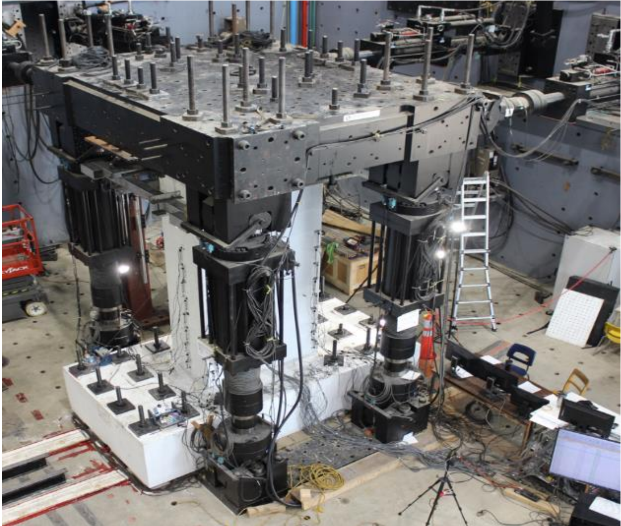
Figure 5.31 Montage de l'essai pour la pile rectangulaire
