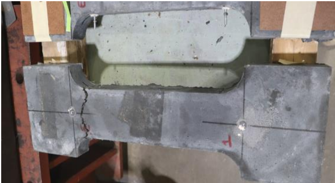
Figure 4.22 Os à l'issue d'un essai de traction, fissuré au changement de section
