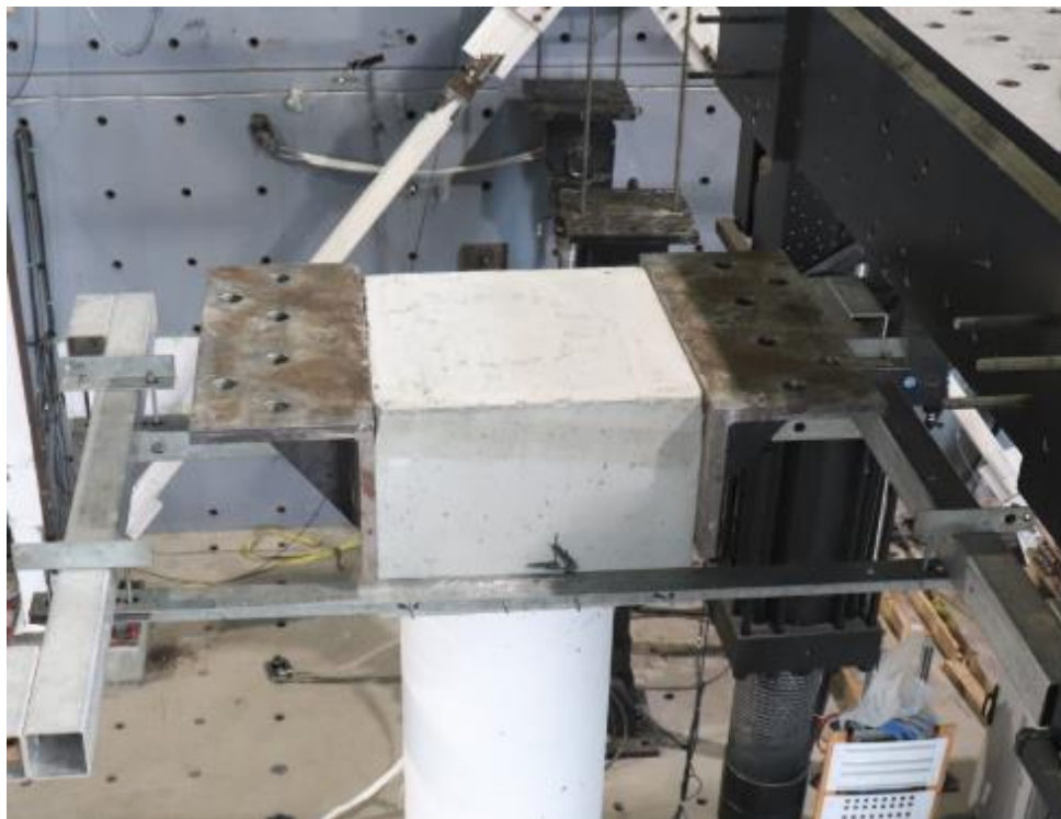
Figure 4.47 Équerres au niveau du chevêtre (P5)
