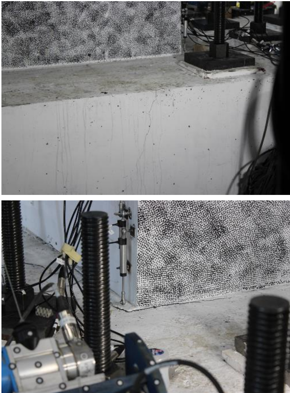
Figure 5.40 Pile à l'issue du préchargement
