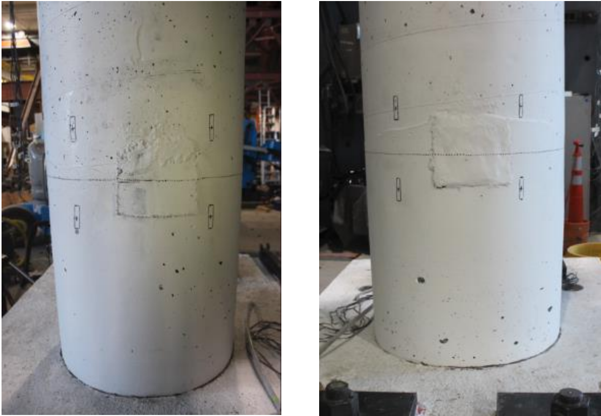
Figure 4.40 Disposition des jauges à béton (P5)
