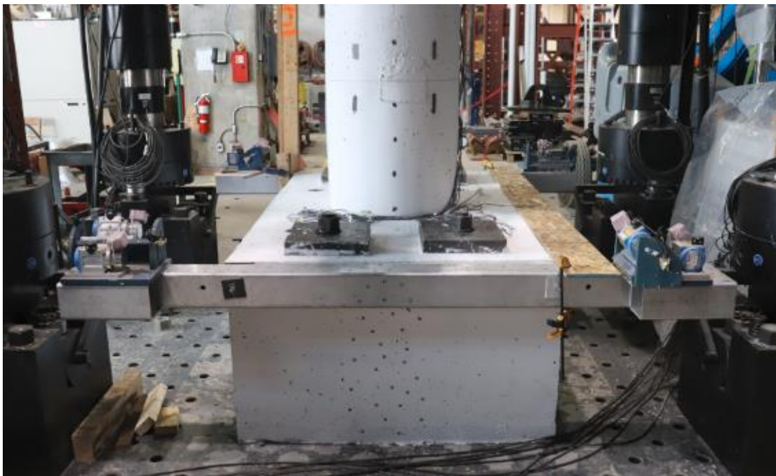
Figure 4.44 Mesure du déplacement relatif – instrumentation au bas de la colonne (P5)
