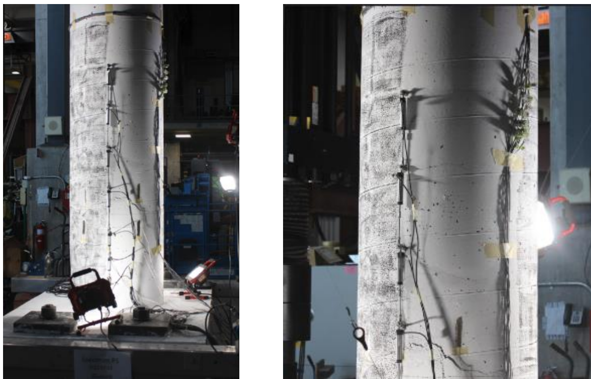
Figure 4.53 Pile P5 à l'issue du préchargement ( 1\Delta_y )
