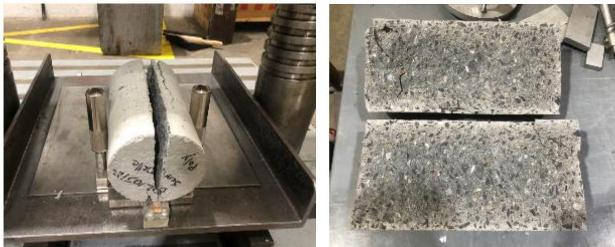
Figure 4.16 Cylindre à l'issue d'un essai brésilien
