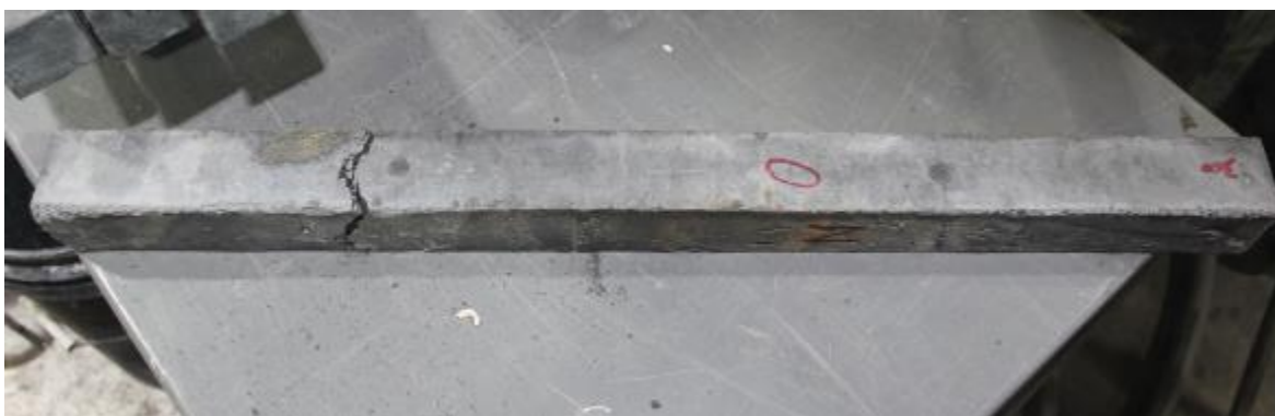
Figure 4.28 Exemple de tirant après essai de traction – fissuration proche des mâchoires
