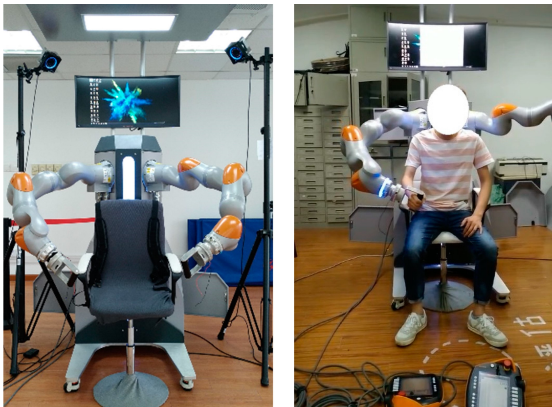
FIGURE 2.3 Le robot EULRR [10], basé sur deux manipulateurs KUKA LBR iiwa
