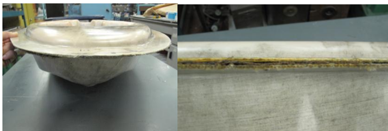
Figure 5-17: Joints entre les deux pièces composant sur les parties planes.
