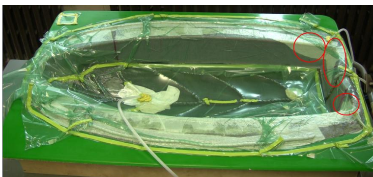
Figure 5-11: Photo du moule après l'infusion et l'ajout d'un second sac à vide.
