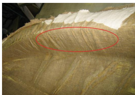
Figure 5-8: Pliure des fibres causée par le manque de pression.
