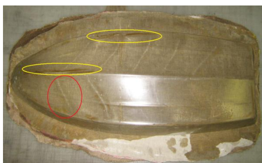
Figure 5-9: Vue de certains défauts sur le dessous du bateau.
