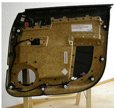
Figure 1-1: Intérieur d'une porte de voiture faites d'un biocomposite de jute et de polyéthylène.
