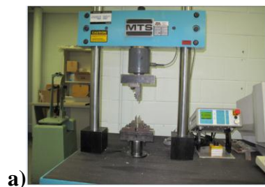
Figure 2-10: a) Machine de test universelle MTS b) Schématisation du test de flexion 3 points et cisaillement courte portée.
