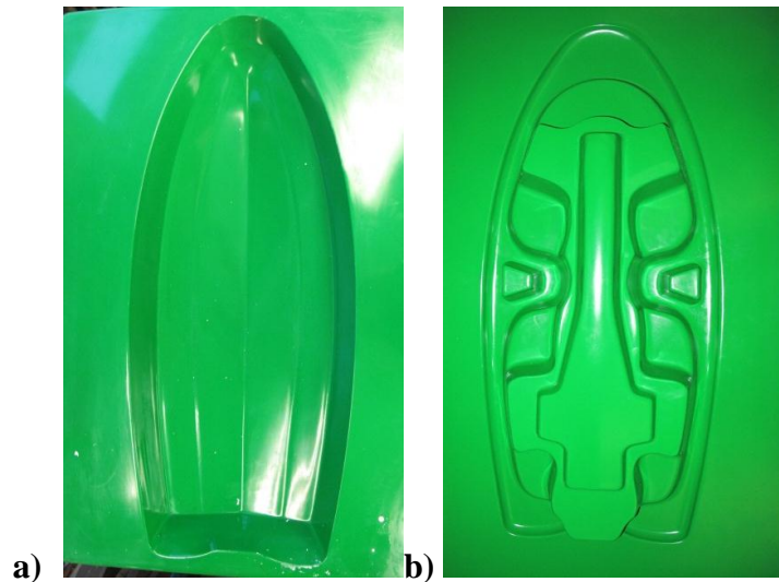
Figure 5-6: Moules du bateau Epic Sail : a) moule inférieur b) moule supérieur.
