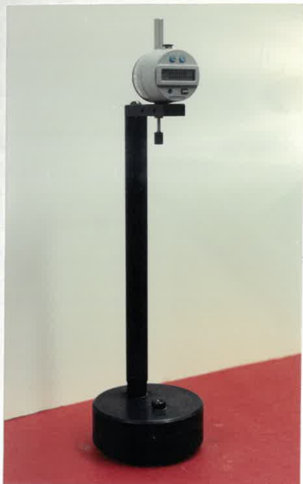
Fig. 11: Appareil de mesure des barres de mortier.
