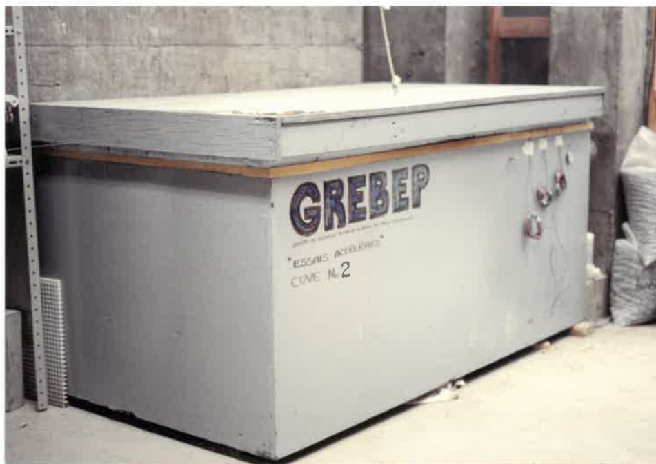
Fig. 13 : Vue extérieure de la cuve isolée servant à la cure à 80° C de l'essai accéléré.
