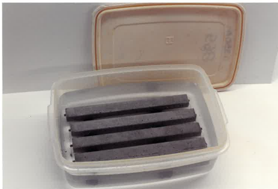
Fig. 14 : Contenant type servant à l'entreposage des barres de mortier pour la cure de l'essai accéléré.
