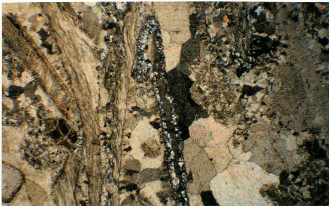
Fig. 15: Calcaire d'Ottawa en lame mince. Présence de chert dans certains fossiles.(X 25) (Lumière polarisée)
