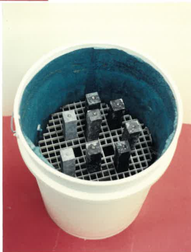
Fig. 12: Contenant type servant à l'entreposage des barres de mortier pour l'essai ASTM C227.
