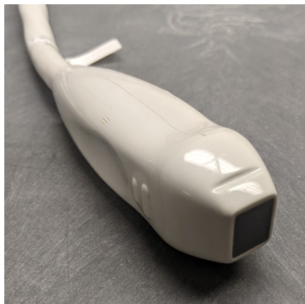
Figure 2-7 | Sonde ultrasonore matricielle 32x32 éléments, 8MHz, fabriquée par Vermon, France.
