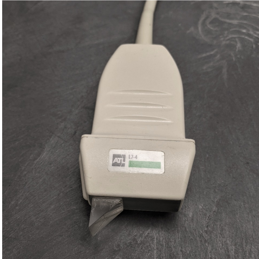
Figure 3-1 | La sonde développée, composée d'une linéaire L7-4 avec un prisme en quartz qui est utilisé comme relais ergodique.
