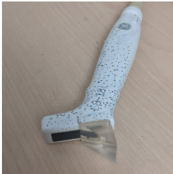
Figure A.7-1 | Sonde L8-18 avec un prisme de quartz apposé sur la moitié des éléments.
