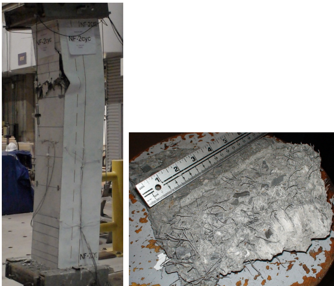
Figure J-27 Photographie du poteau NF-2cyc : a) Vue d'ensemble du poteau dans la partie post-pic (de gauche à droite : faces ouest et sud ) b) Morceau de béton de fibres qui s'est désolidarisé durant le test
