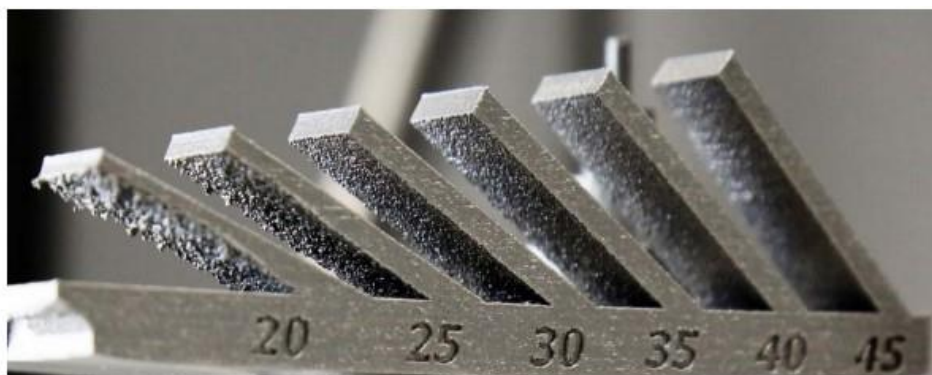
Figure 2.33 Échantillons d'acier bruts d'impression par la méthode PBF (Tirée de www.additivemet.com )
