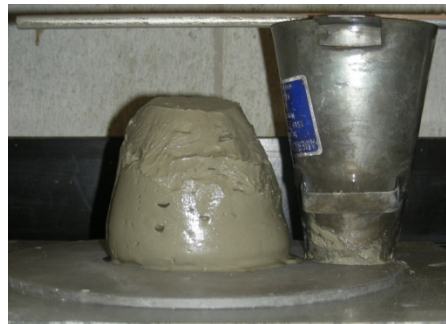
Figure 3.8 : Procédure de mesure de l'affaissement ( slump test ) au petit cône d'Abrams
