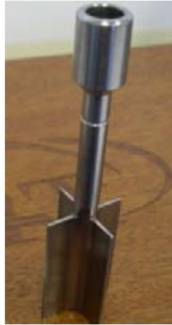
Figure 3.6 : Géométrie de moulinet ou « Vane » (TA Instruments)
