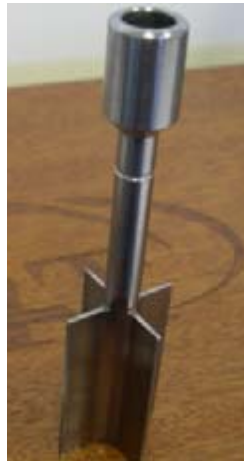
Figure 3.6 : Géométrie de moulinet ou « Vane » (TA Instruments)
