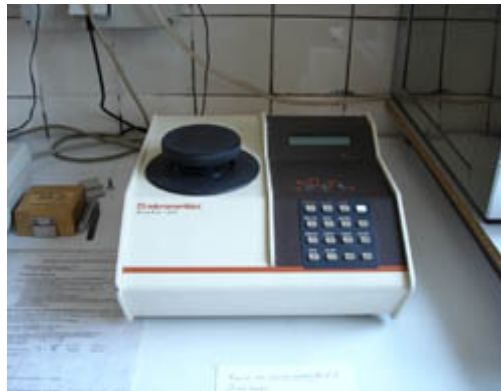
Figure 3.1: Pycnomètre à hélium AccuPyc 1330 de Micromeritic
