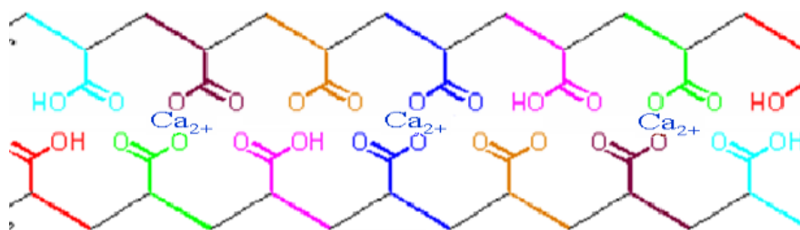
Figure 2.12: Complexation des cations Ca 2+ par les fonctions carboxylates (Castel et al. 1990).
