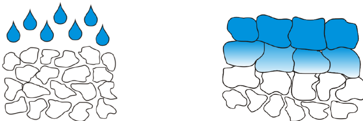
Figure 2.18 : Illustration du phénomène de gel blocking (Buchholz 2006)
