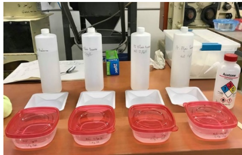
Figure 3.6: Mélange de solutions (eau déionisée, solutions de chlorure et de sulfate) avec PSA
