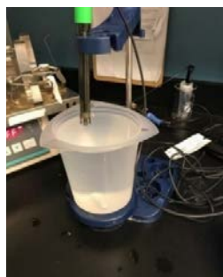
Figure 3.11: Stylet de malaxage et solution (acide ou basique) pour la détermination du pH.
