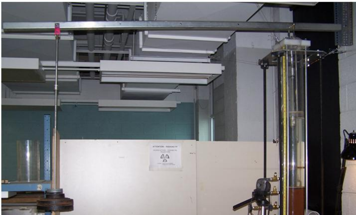
Figure 2.35 : Vue d'ensemble du système des surcharges avec le bras de levier; on voit aussi la fixation au mur en béton et l'appui sur la tige principale du système.
