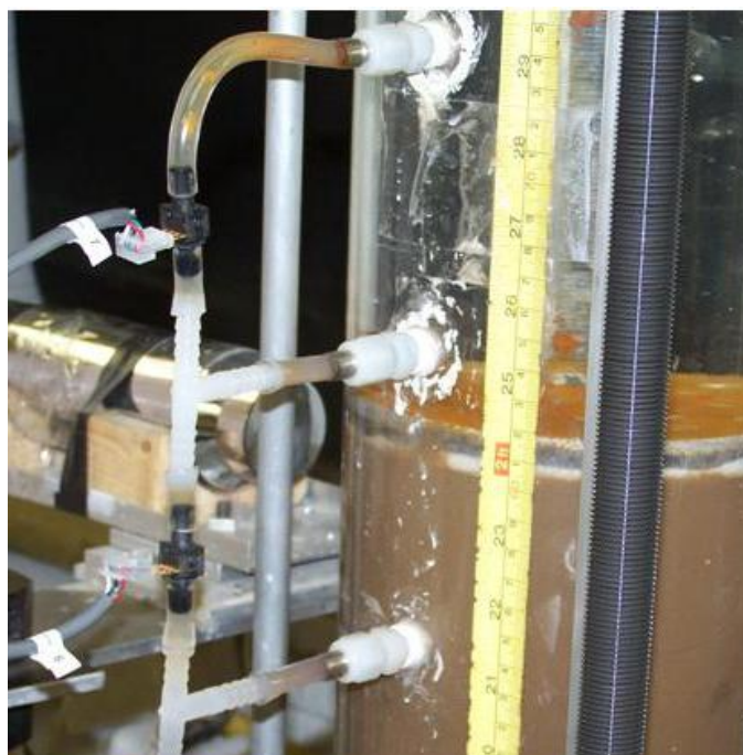
Figure 2.33 : Capteurs de pression différentielle fixés à la grande colonne d'essai.
