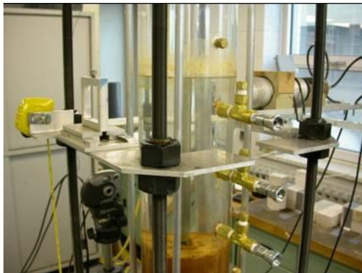
Figure 2.14 Support mobile et accouplements de mesure de la pression d'eau
