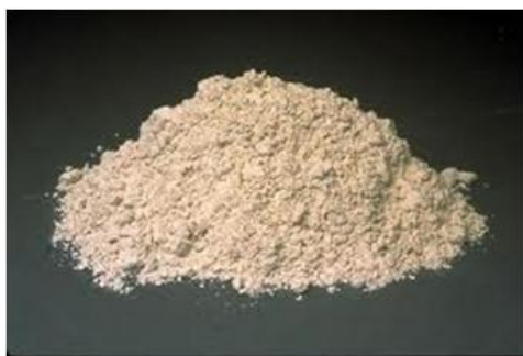
Figure 2.10: Image du laitier utilisé comme adjuvant.
