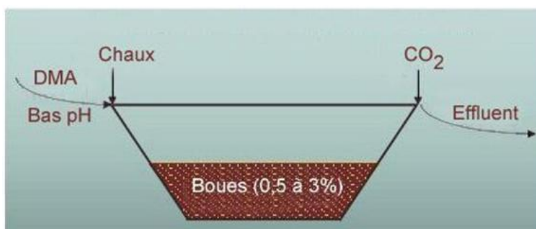
Figure 1.5 : Bassin de sédimentation avec chaulage (Tiré de Aubertin et al., 2002)
