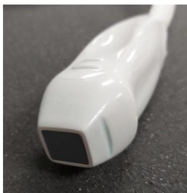
Figure 2.8 - Sonde ultrasonore matricielle 32x32 éléments, 8MHz, fabriquée par Vernon, France.
