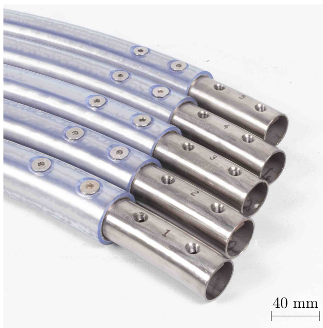
Figure 6.2 Pièces de connexion pour une roue Cyr classique. Les différentes parties, en noir, sont reliées entre elles par des manchons et des vis. La roue est également recouverte d'un revêtement en PVC de 2,5 mm d'épaisseur [24].
