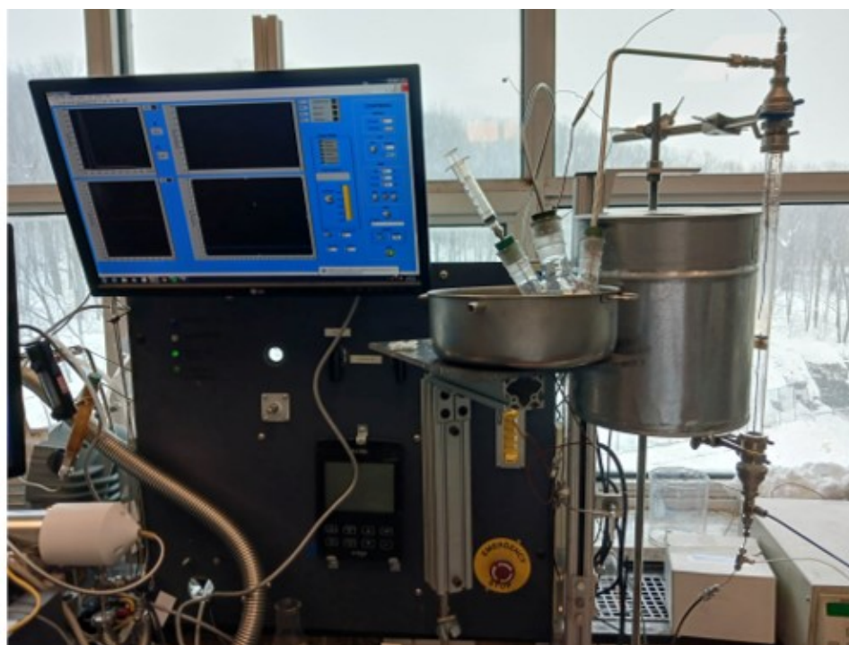
FIGURE 3.2 Montage expérimental du réacteur à lit fluidisé (sans le condenseur)
