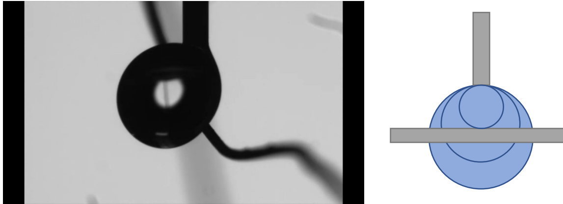
Figure 69 (a) Phénomène observé lors des tests d'angle de contact sur les fils recouverts de NTC et (b) effet sur la prise de mesure perpendiculaire au fil.
