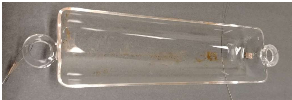
Figure 44 Bateau de quartz permettant de supporter les échantillons lors des expériences
