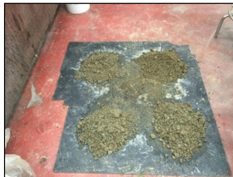
Figure 3.3 : Homogénéisation des MTBs par quartage (méthode de quatre coins)
