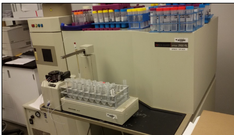
Figure 3.9 : Dispositif de l'analyse ICP-AES (UQAT)
