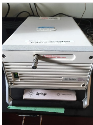
Figure 3.30 : Chromatographe en phase gazeuse Agilent MicroGC-3000A (URSTM-UQAT)
