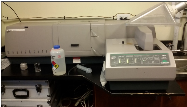
Figure 3.5 : Granulomètre laser Malvern Mastersizer (UQAT)
