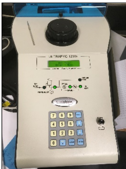
Figure 3.4 : Pycnomètre à hélium (UQAT)
