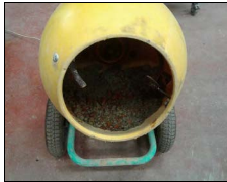
Figure 3.2 : Malaxeur utilisé pour la préparation des mélanges MTBs
