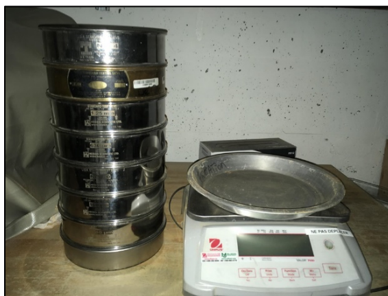
Figure 3.6 : Série des tamis ASTM D422-63 (UQAT)
