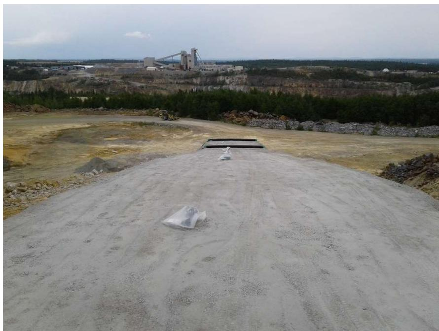
Photo B-4 : Vue depuis la station PW6. Disposition des stations de mesure in situ (premier plan) et des drains de collecte des eaux de ruissellement sur la pente à 20% et à 10% (second plan)
