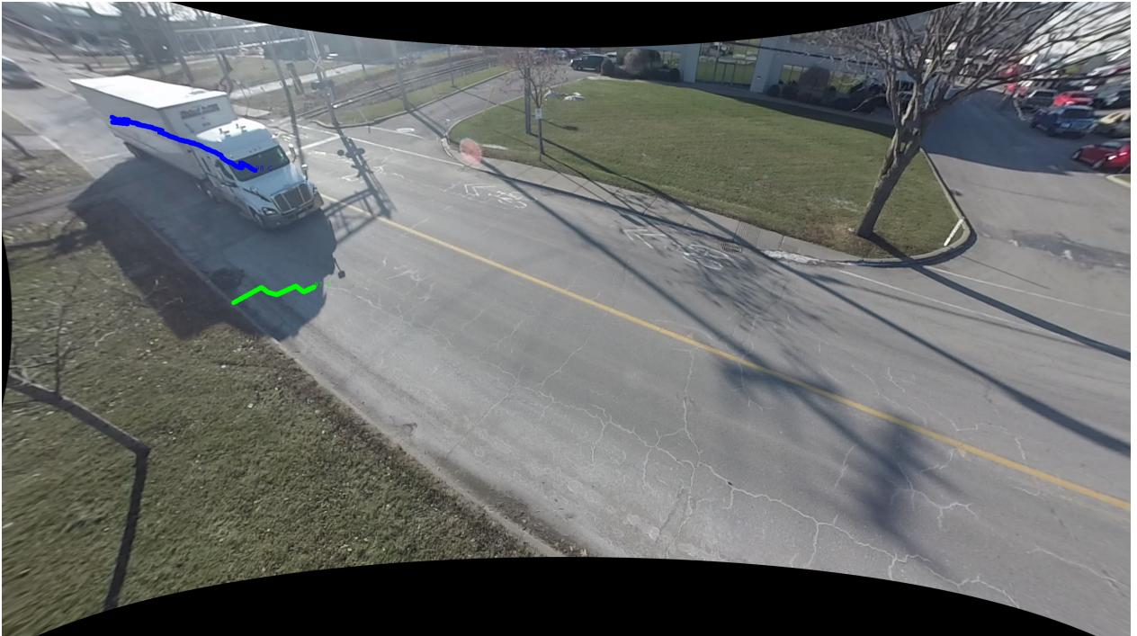
Figure 3.10 Exemple de sur-segmentation dû à l'ombre d'un usager.
