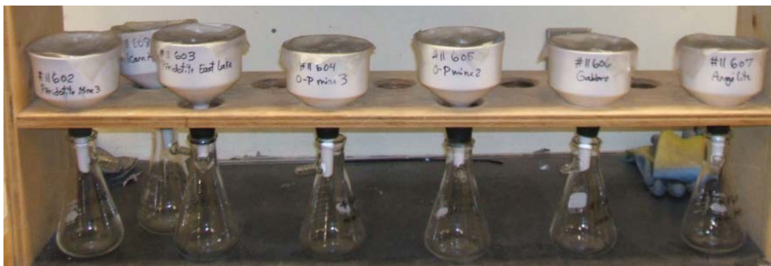
Figure 3-5: Photo des mini-cellules d'altération de cette étude
