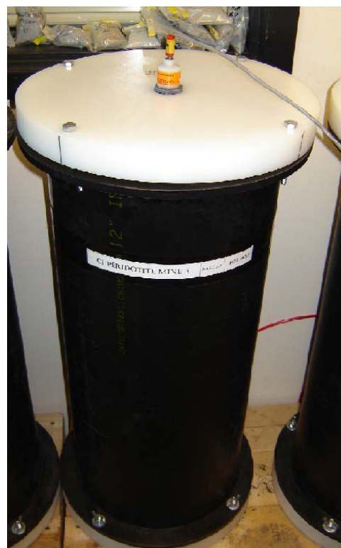
Figure 3-4: Configuration et photo d'une colonne lors des essais de consommation d'oxygène
