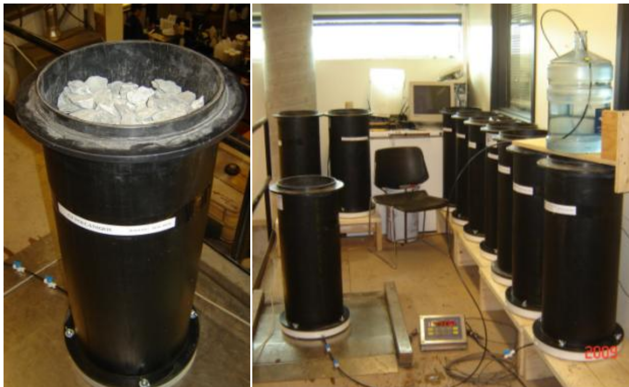
Figure 3-3: Colonnes et remplissage d'une colonne d'eau déionisée à partir d'un réservoir en hauteur (à droite)
