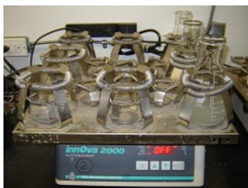
Figure 3-7: Photographie des essais de sorption agités
