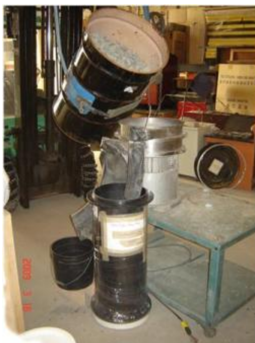
Figure 3-1: Tamisage des matériaux des colonnes C1 à C9
