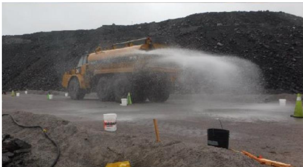
Figure 2.10: Camion-citerne utilisé pour les essais d'infiltration à grande échelle sur la halde expérimentale de la mine du lac Tio (crédit IRME).
