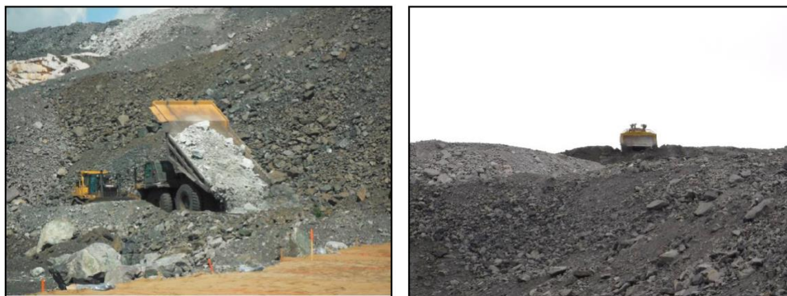
Figure 2.1 : (a) Déversement à la benne ( end-dumping ), et (b) épandage au butoir ( push dumping ) (tiré de de Bussière et al, 2015)
