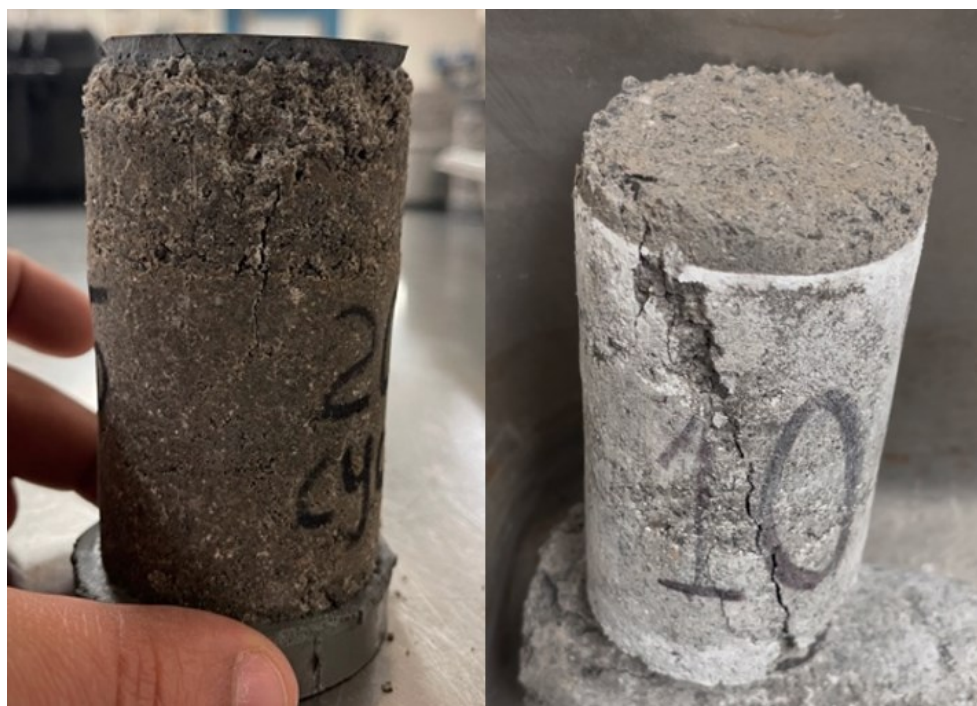
Figure 4.13 – Comparaison d'un échantillon testé 3 heures après le cycle gel-dégel avec un autre testé 24 heures après le cycle
