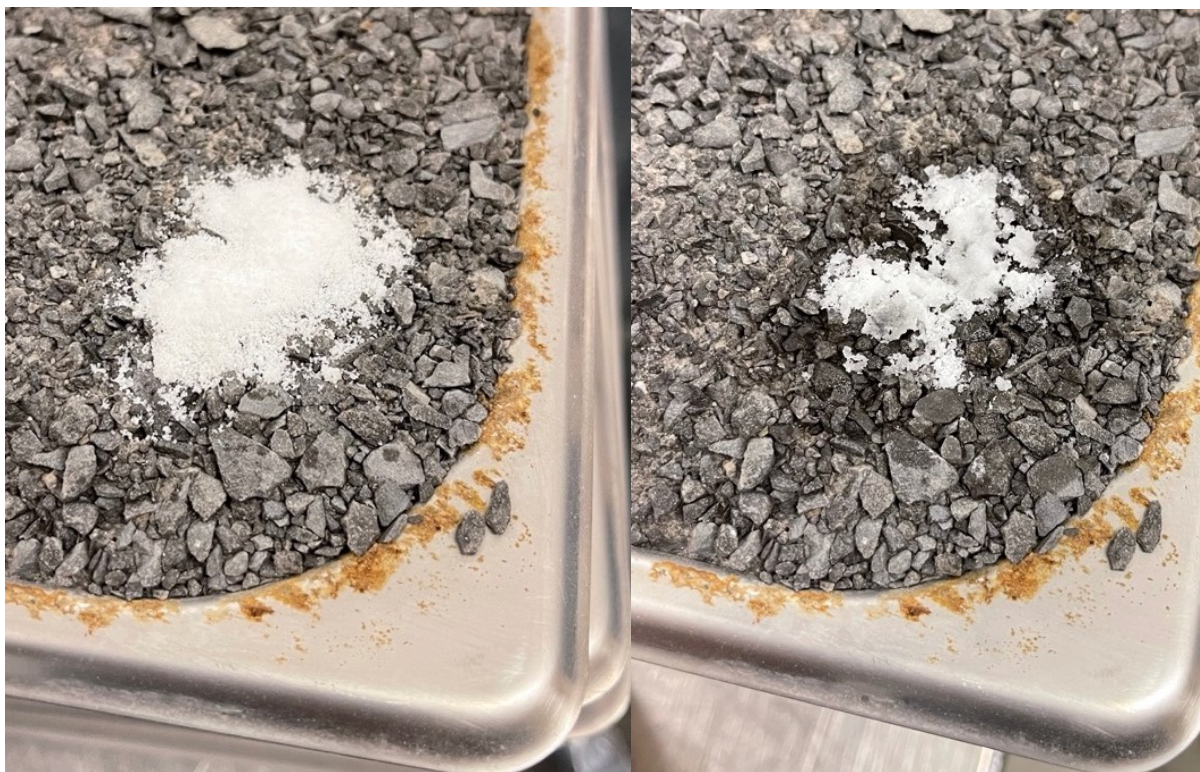
Figure 3.9 – État du \text{CaCl}_2 après 30 minutes de contact avec le sol et l'humidité de l'air
