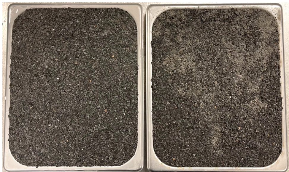
Figure 4.17 – Comparaison entre les échantillons E-1 et E-4 après l'essai d'érosion
