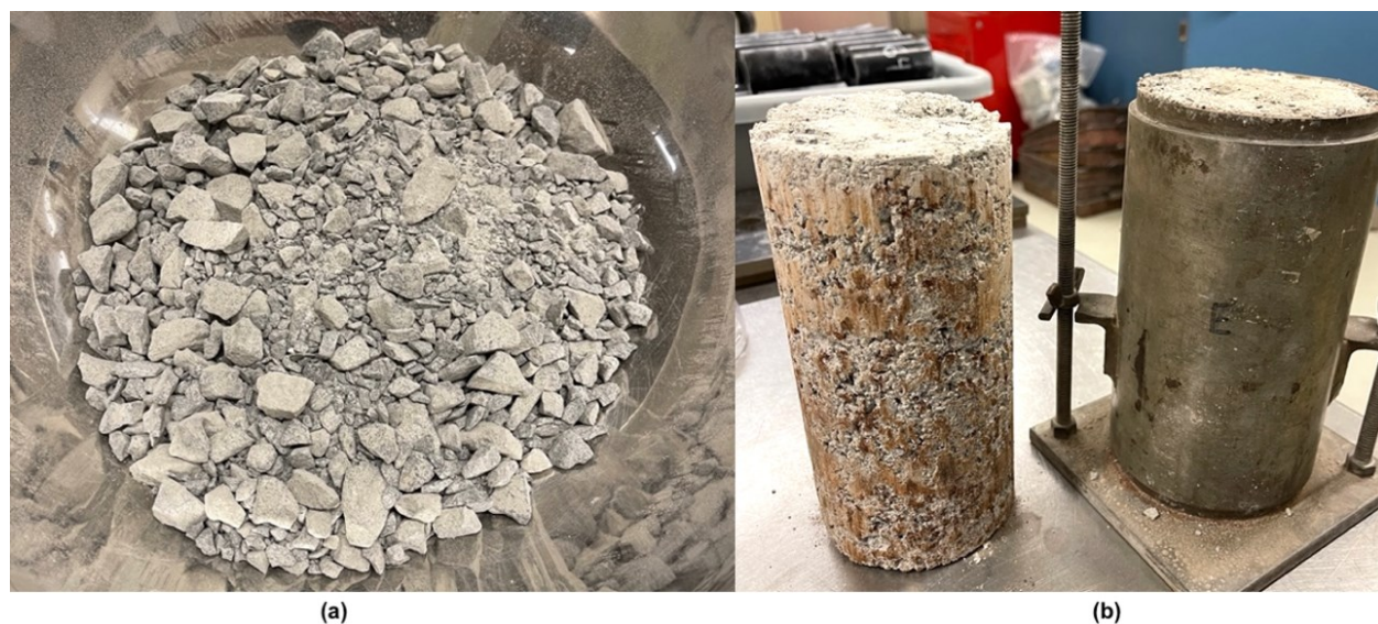
Figure 4.25 – Échantillons de pierre concassée avant et après compactage dans le moule en acier Les échantillons ont été préparés à partir du mois de décembre, mais comme il n'y avait qu'un seul moule, seul un échantillon à la fois a pu être préparé tous les 15 à 20 jours. Au total, 8 échantillons ont été préparés et testés le 3 mai 2022 au laboratoire des structures en béton. Les 8 échantillons préparés et l'exécution de l'essai sur la presse Amsler dans le laboratoire de structure de Polytechnique Montréal à la Figure 4.26.
