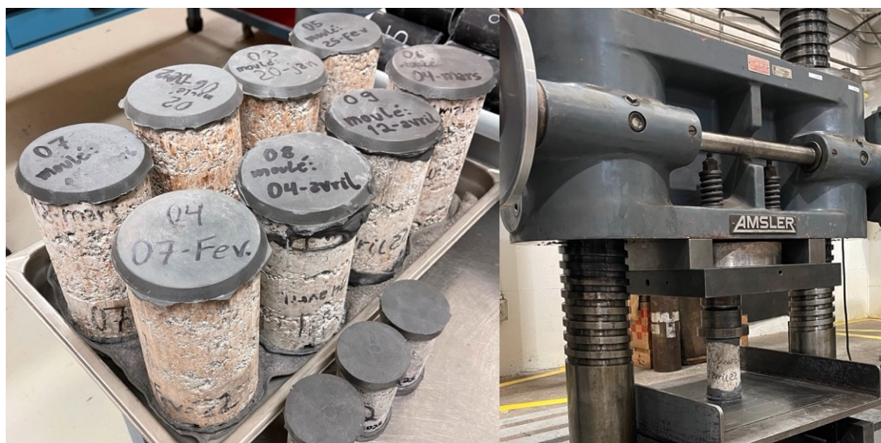
Figure 4.26 – Échantillons de pierre concassée avant et pendant l'exécution des essais de compression simple
