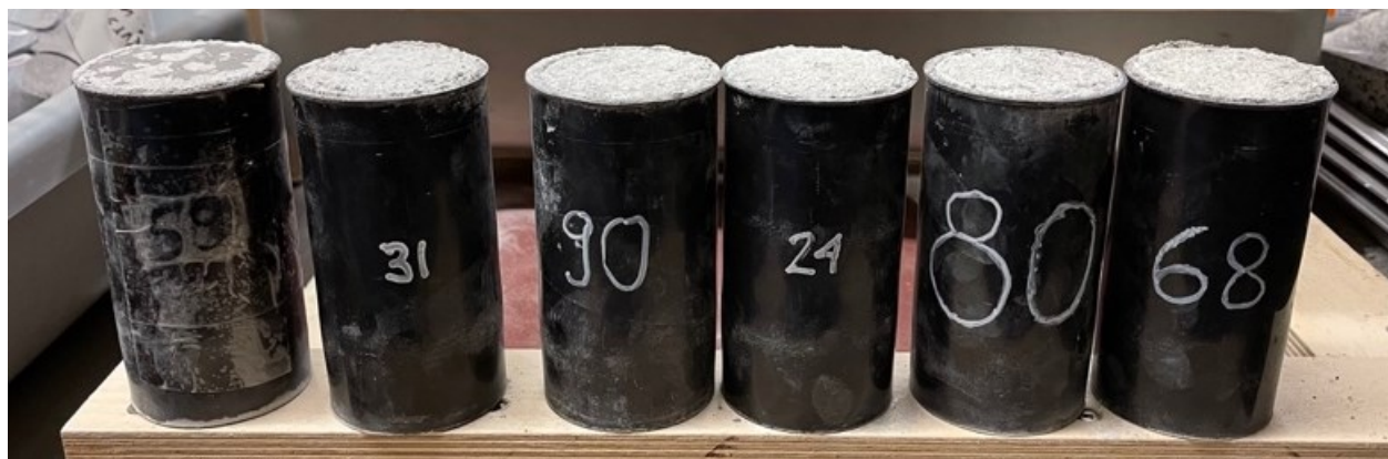
Figure 3.38 – Échantillons préparés pour l'évaluation de l'effet du temps de préparation sur le comportement mécanique
