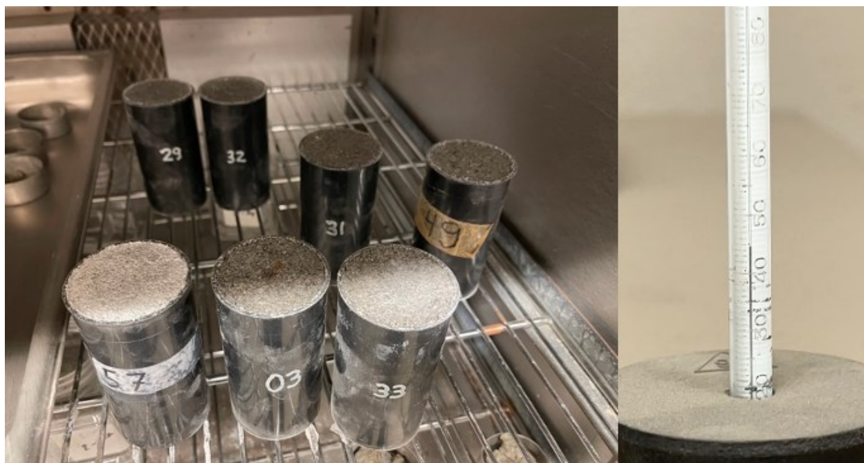
Figure 3.25 – Étape de cure thermique ( 45^{\circ}\text{C} \pm 1^{\circ}\text{C} ) du traitement de calcification chimique
