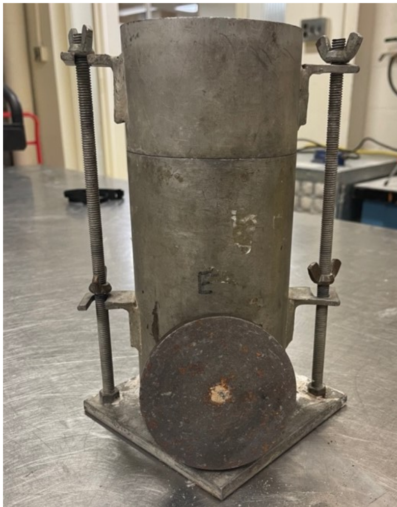
Figure 3.13 – Moule en acier galvanisée et plaque métallique utilisé pour compacter le MG-20
