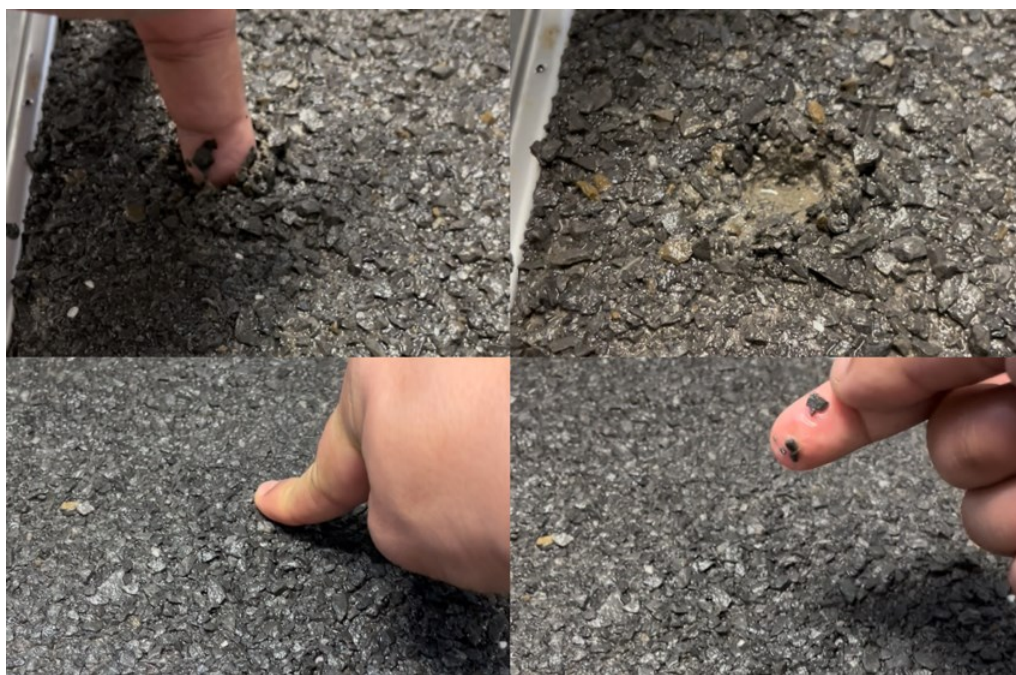
Figure 4.21 – Comparaison entre la rigidité des échantillons E-3 et E-5
