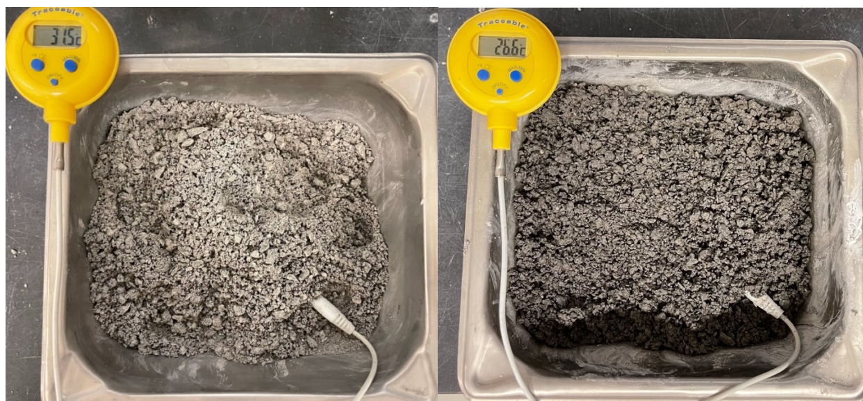
Figure 4.7 – Comparaison de la texture des deux sols, 1 heure du début de la réaction
