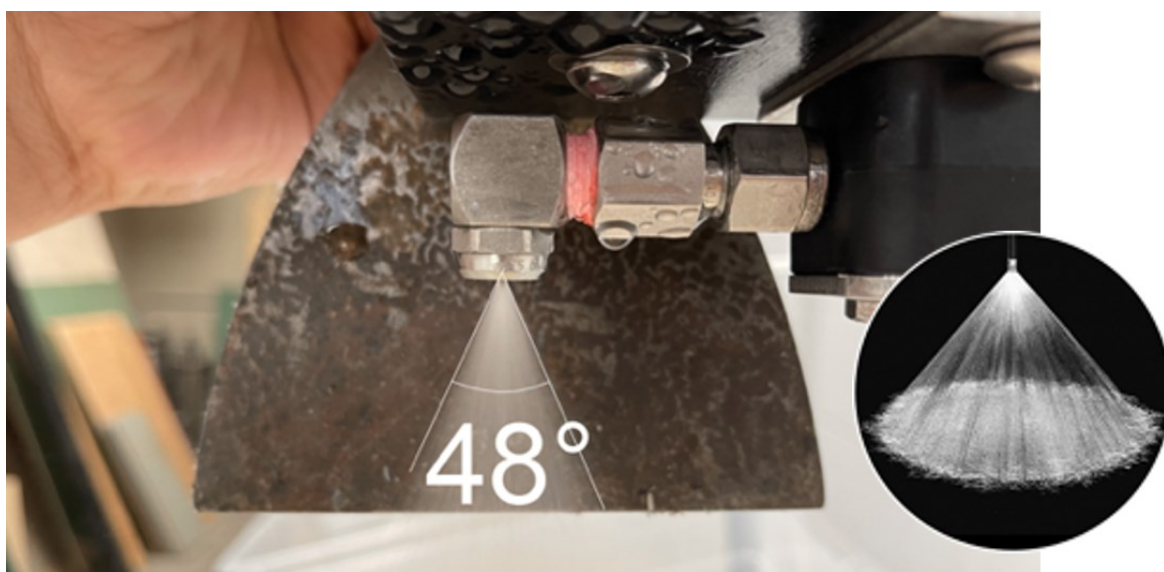
Figure 3.37 – Jet conique réalisé par la buse de pulvérisation
