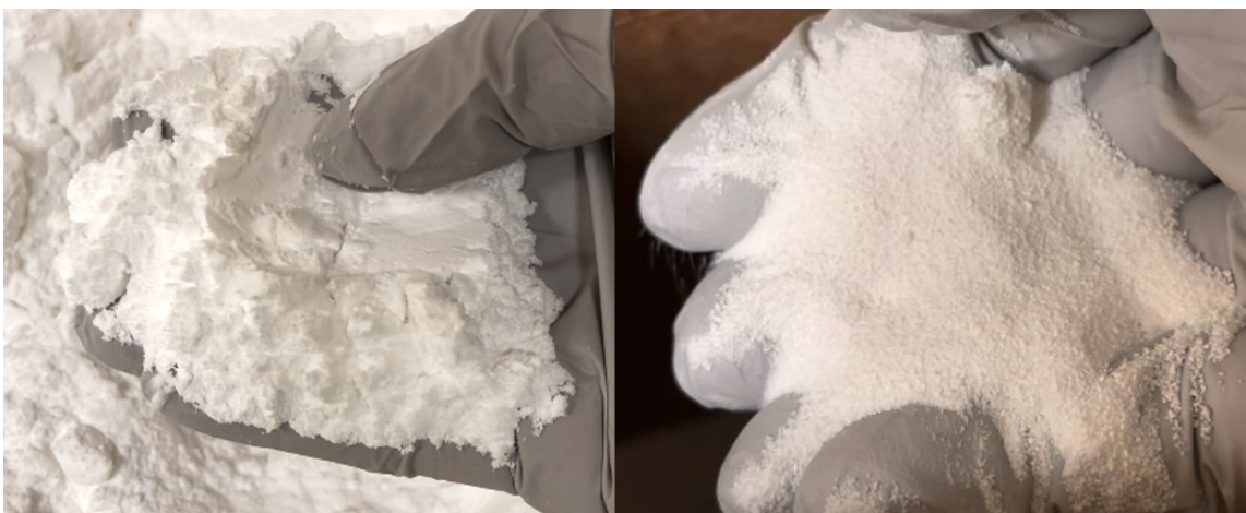
Figure 4.4 – Texture des carbonates de sodium Solvay Light (à gauche) et A&H (à droite)
