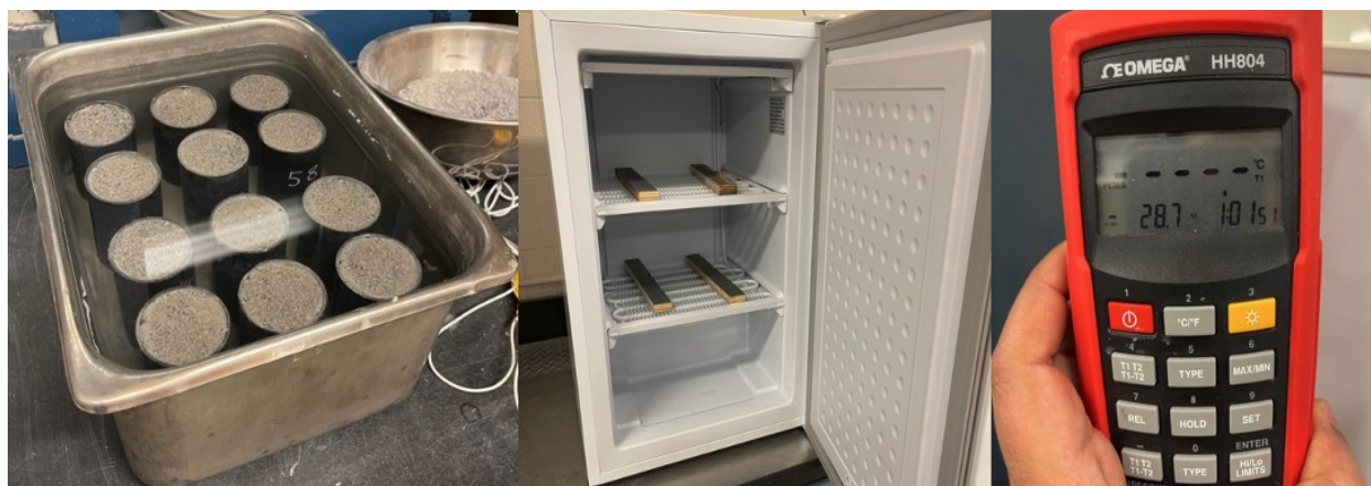
Figure 3.32 – Les équipements utilisés pour l'exécution des essais de cycle gel-dégel.
