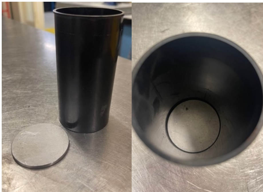
Figure 3.10 – Moule en tuyaux d'ABS et plaque métallique utilisée pour le compactage de la poussière de roche
