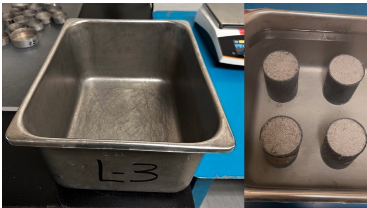
Figure 3.31 – Type de conteneur utilisé et moment de l'exécution des tests d'immersion
