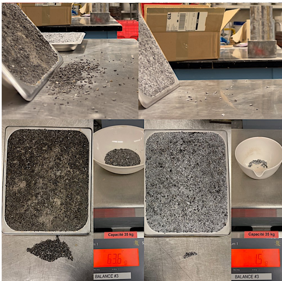
Figure 4.22 – État de la couche la plus externe des échantillons E-3 et E-5 avant et après essai
