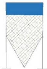
Figure 2.8 Épaississeur de haute densité (Jewell et al., 2006)
