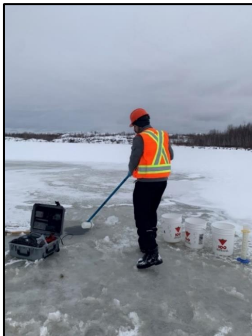
Figure 3.14 Réalisation de mélanges sur le terrain à l'aide d'une perche d'échantillonnage munie d'une bouteille de 1 L HDPE et d'une éprouvette graduée d'un litre (2022-11-23)
