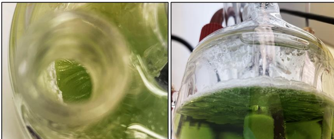
Figure 6-5 Précipitation des cristaux de \text{FeSO}_4 \cdot 7\text{H}_2\text{O} – 360 minutes
